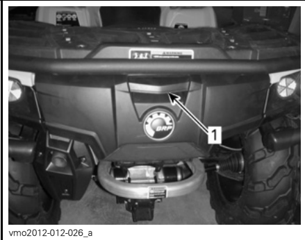
TYPBILD - 1000-MODELL VISAS 1. Spärr till bakre förvaringsutrymme
