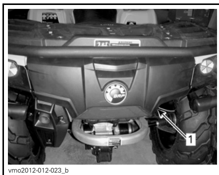
TYPBILD - 1000-MODELL 1. Lock till bakre förvaringsutrymme
