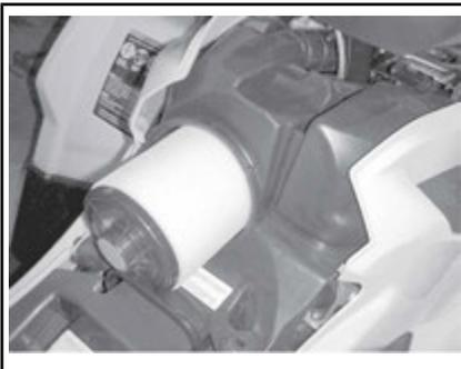
**REMOÇÃO DO FILTRO DE AR****Limpeza e lubrificação do filtro de ar**
