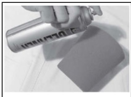
SITUAZIONE TIPICA - SPRUZZARE L'ELEMENTO IN MATERIALE ESPANSO
