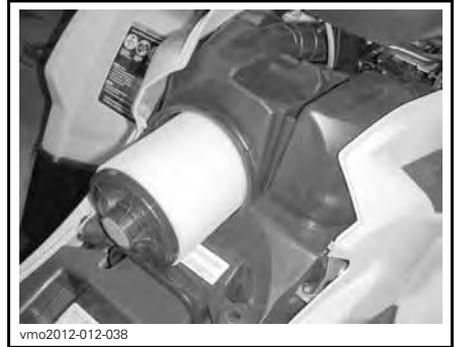
**DÉPOSE DU FILTRE À AIR****Nettoyage et huilage du filtre à air**
