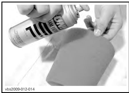
TYPIQUE - LUBRIFICATION DE L'ÉLÉMENT DU FILTRE EN MOUSSE
