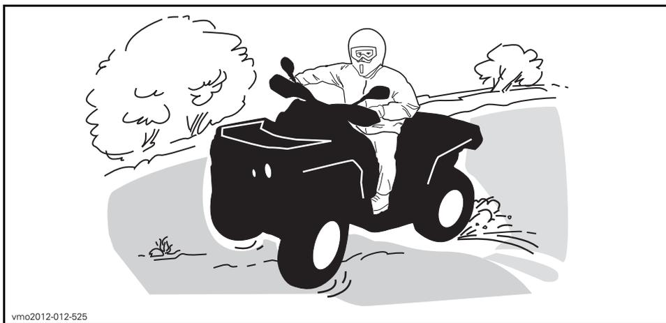
Si le véhicule se met à glisser, tourner le guidon dans le même sens que la direction du glissement jusqu'à reprendre le contrôle du véhicule. Ne jamais serrer les freins à fond ou bloquer les roues.
