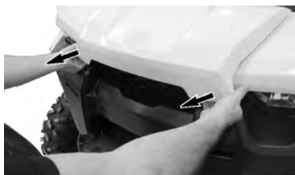
TIRARE DAL BORDO COPERCHIO DI MANUTENZIONE ANTERIORE.
