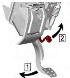
Vaihe 1. Paina jarrupoljinta ja pidä se painettuna Vaihe 2. Nosta vipua
