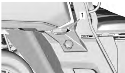
1. Alça de liberação do compartimento de carga
