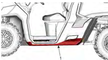
1. Barra di protezione laterale
