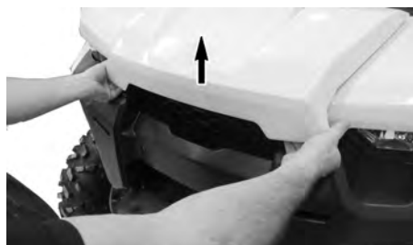
LEVANTANDO A BORDA DA TAMPA DE MANUTENÇÃO FRONTAL.
