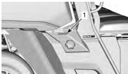
1. Alça de liberação do compartimento de carga
