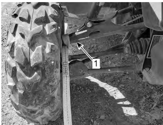
1. Braço da suspensão superior dianteira
