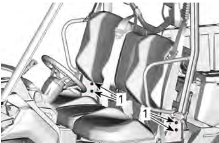
1. Sujeciones inferiores de la jaula
