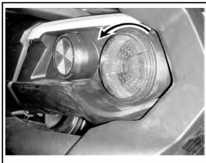
*RÜCKLEUCHE ZUM ENTFERNEN GEGEN DEN UHRZEIGERSINN DREHEN*
