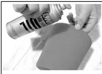
TYPISCH - SCHAUMFILTERELEMENT ÖLEN
