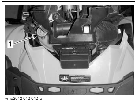
1. Beholder for motorkjølevæske
