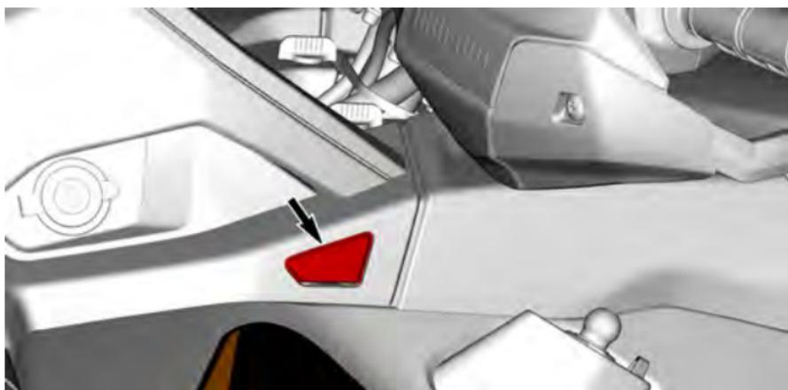
4. Asegure la consola con los tornillos de un cuarto de vuelta, girándolos en sentido horario.
