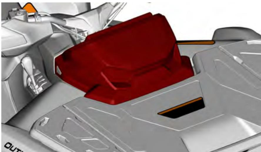
3. Compruebe que el fluido se sitúe entre las marcas de nivel MÍNIMO y MÁXIMO del depósito para refrigerante.
