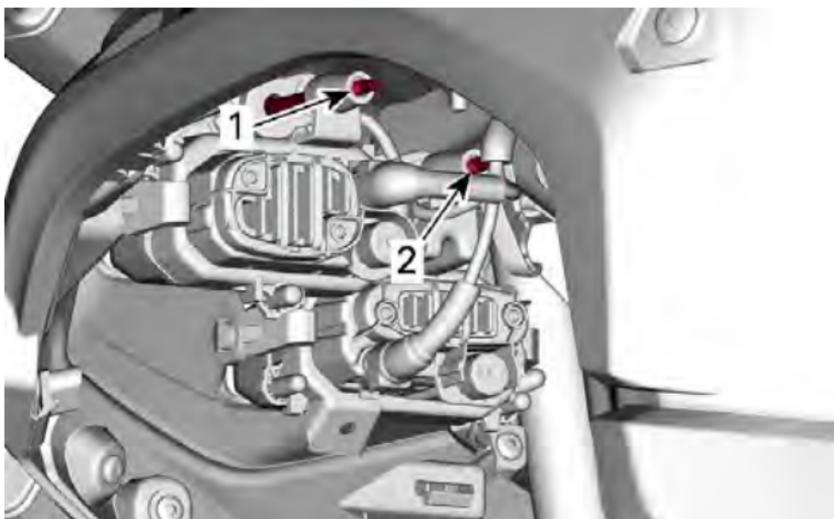
1. Tornillo de ajuste de luces bajas.
