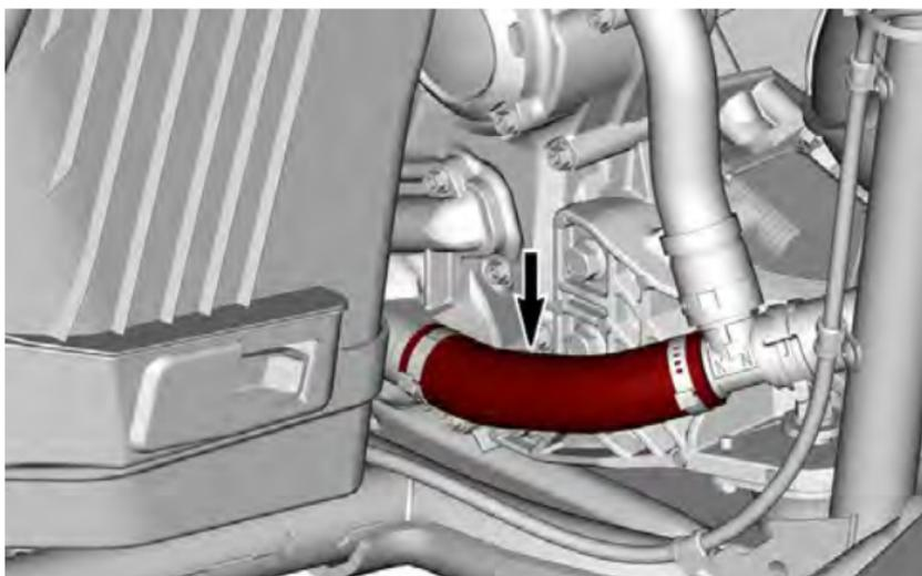
4. Apriete el tapón de drenaje del refrigerante con una arandela de cobre **NUEVA** según las especificaciones.
