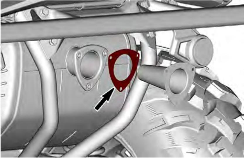
4. Elimine los depósitos de carbonilla del supresor de chispas, utilizando un cepillo metálico con cerdas suaves.
