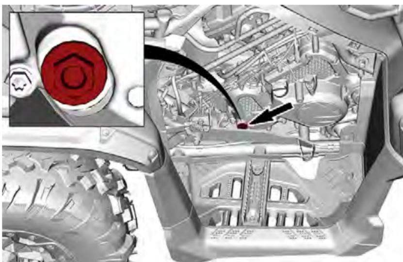
5. Compruebe el nivel de aceite. El aceite debería estar a ras de la parte inferior del orificio del nivel de aceite.
