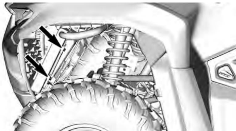
3. Desconecte el conector del ventilador del radiador.
