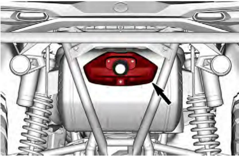
10. Asegure la moldura del escape utilizando tornillos nuevos. Apriete según las especificaciones.
