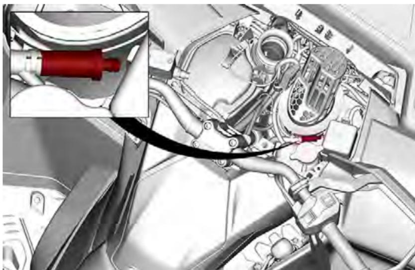
1. Por el lado derecho de la consola, retire las mangueras del filtro.
