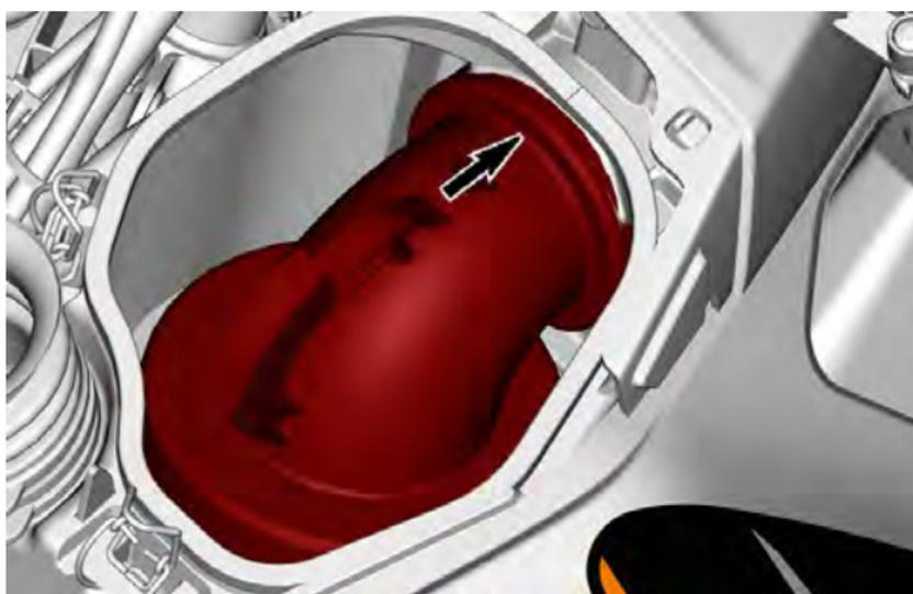
4. Coloque la cubierta de la carcasa del filtro de aire.
