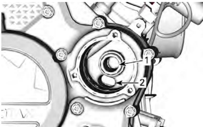
1. Orificio de salida al sistema de suministro de aceite al motor
