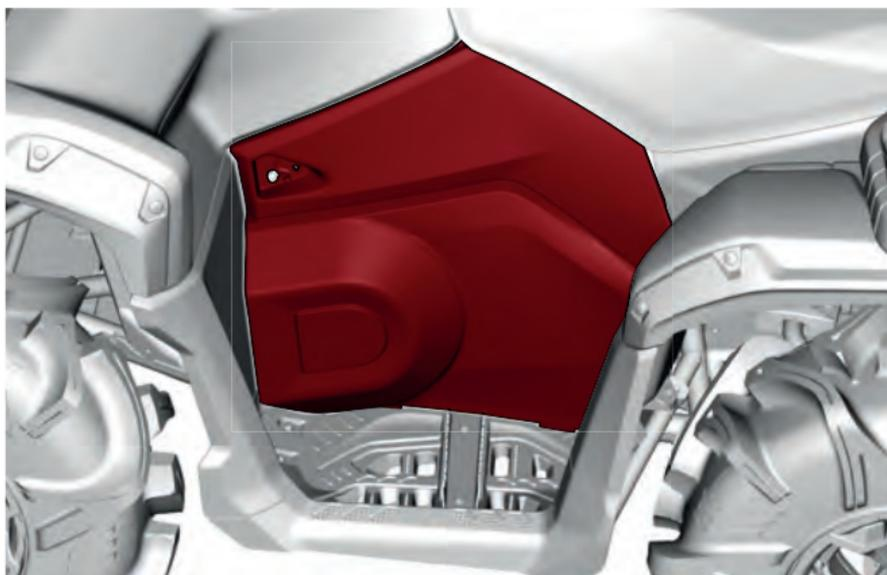
2. Remova o para-lama interno dianteiro esquerdo.
