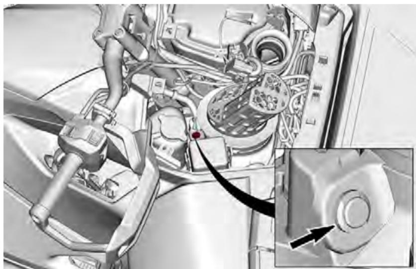
3. Instale uma nova braçadeira de cabo e aperte a braçadeira de mangueira.
