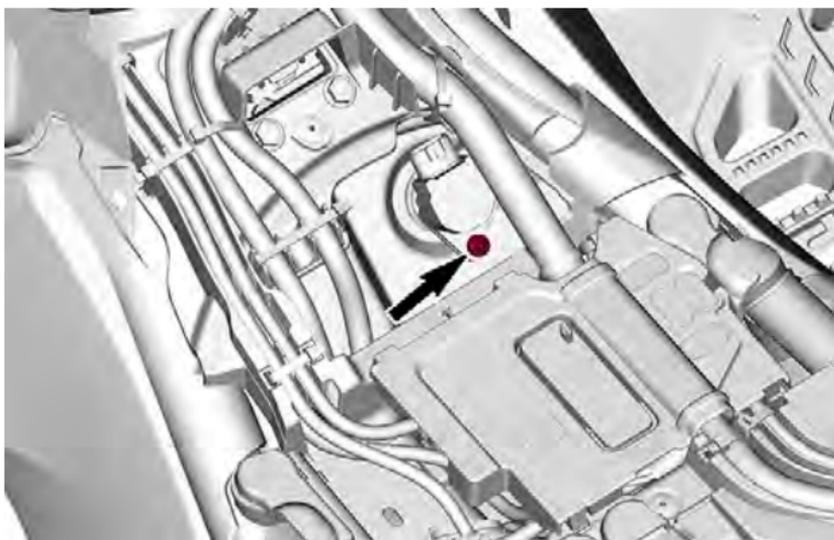
6. Retire a bobina de ignição.
