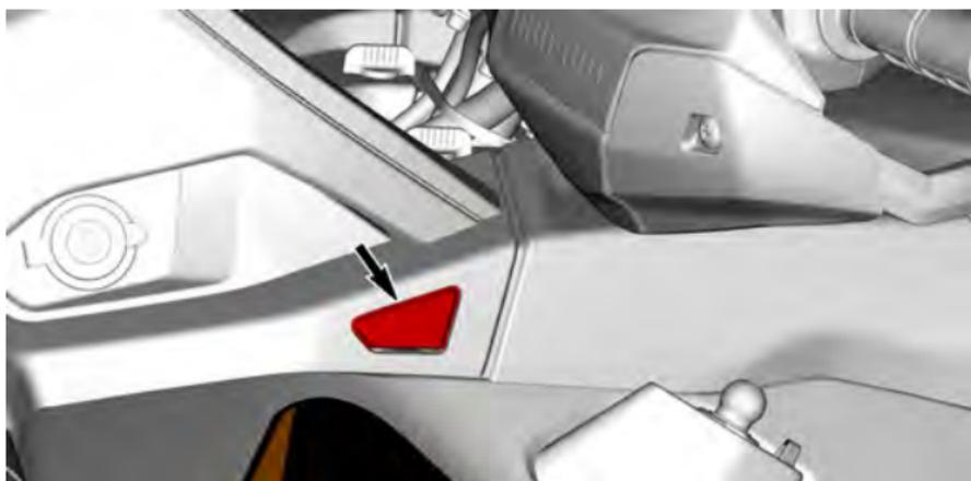
4. Fixe o console usando os parafusos de um quarto de volta girando-os no sentido horário.
