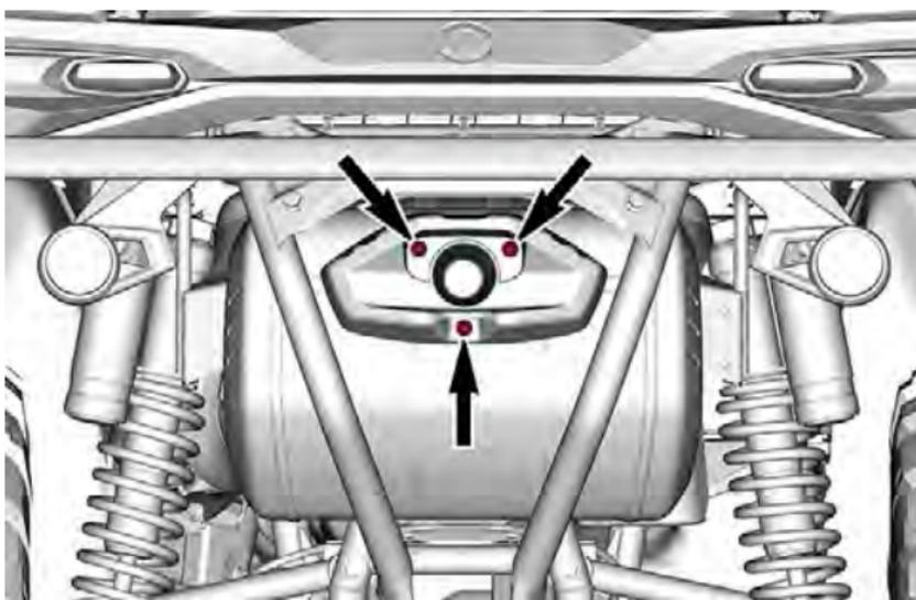
2. Remova a guarnição do escapamento.
