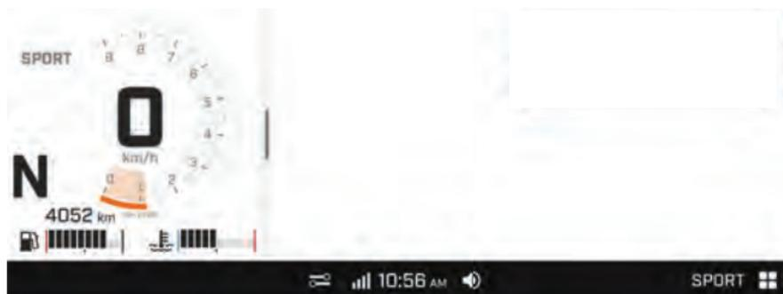
Na exibição estreita, pressione longamente o medidor de percurso para mostrar um dos itens a seguir. Use pressionamentos longos adicionais para percorrer os itens.
