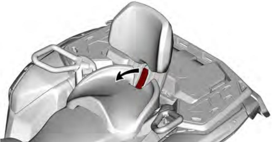
2. Enquanto mantém a alavanca de trava puxada em direção a parte dianteira, aplique pressão para baixo na parte traseira da alavanca de trava para desencaiar a trava traseira do pino e mudar o assento para a frente usando o encosto do banco.
