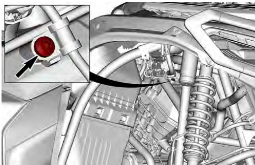
6. Desligue o conector da bobina de ignição.
