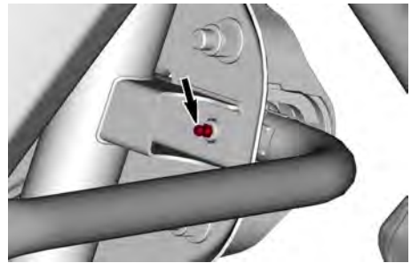
BAKRE KRÄNGNINGSHÄMMARE – VÄNSTER SIDA – TYPBILD
