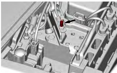
7. Conecte a outra extremidade da ponta auxiliar PRETA ao polo negativo (-) da bateria do outro veículo.
