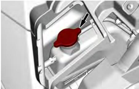
2. Adicione líquido de arrefecimento até atingir a linha MAX no reservatório de líquido de arrefecimento. Consulte *Líquido de arrefecimento do motor recomendado*. Use um funil para não derramar. **Não complete além da capacidade.**
