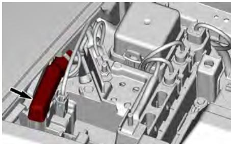
4. Comece conectando uma extremidade da ponta auxiliar VERMELHA no polo positivo (+) da bateria descarregada.
