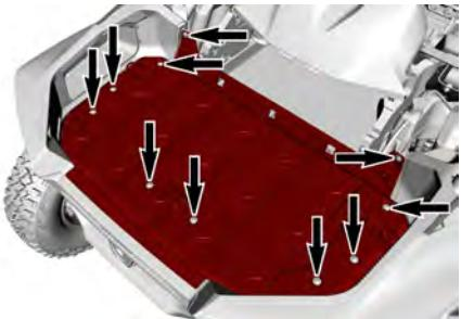
9. Remova os parafusos que prendem os defletores acústicos no suporte do intercooler e no chassis. Depois, remova o defletor de cada lado do intercooler.
