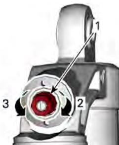
**AMORTECIMENTO POR COMPRESSÃO EM ALTA VELOCIDADE (USE UMA CHAVE INGLESA DE 17 MM)**
