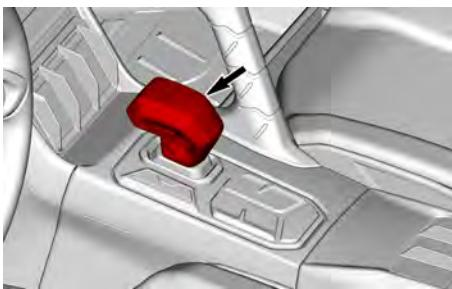
A alavanca é usada para colocar a transmissão em MARCHA À RÉ ou DRIVE (para frente).
