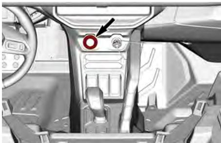
Com a chave D.E.S.S. inserida, pressione e segure o botão PARTIDA/PA-RADA DO MOTOR para ligar o motor.
