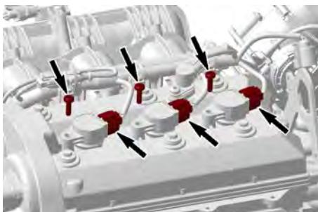
3. Remova as bobinas de ignição com as gaxetas da vela de ignição girando a bobina de um lado para o outro enquanto puxa para cima.
