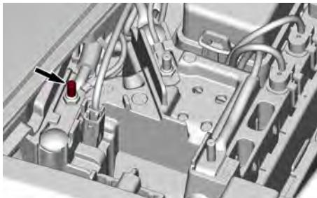
5. Em seguida, ligue a outra ponta do cabo auxiliar VERMELHO ao polo positivo (+) da bateria do outro veículo.
