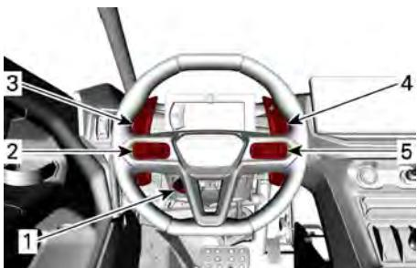
1. Alavanca de inclinação/telescópica
