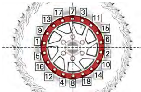
TYPISCH - AANDRAAIVOLGORDE
