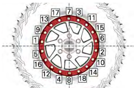
TYPISCH - AANDRAAIVOLGORDE
