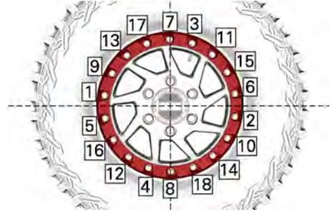
SITUAZIONE TIPICA - SEQUENZA DI SERRAGGIO
