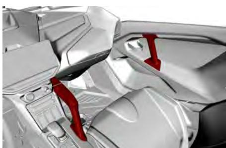
Die Haltegriffe dienen dazu, dass sich der Beifahrer bei starken Fahrzeugbewegungen an ihnen festhält und bei einem Überschlag seine Hände sowie sein gesamter Körper im Cockpit bleiben.
