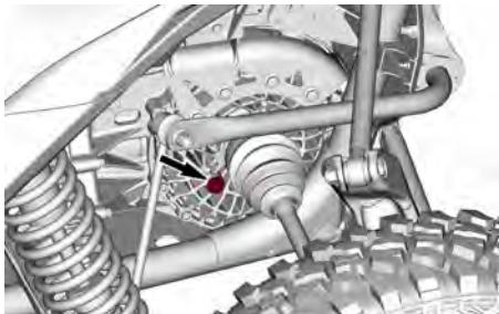
4. Entfernen Sie die Ölfüllstandschraube des Hinterachsgetriebes und den O-Ring.
