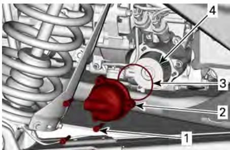
1. Schrauben der Ölfilterabdeckung
