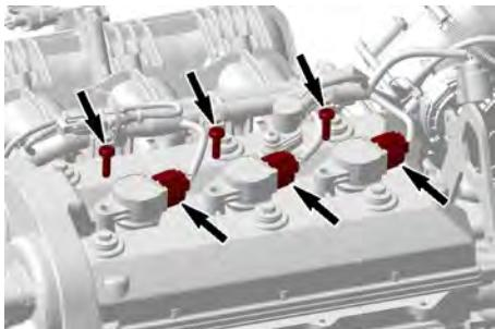
3. Nehmen Sie die Zündspule mit den Dichtungen aus der Zündkerze. Drehen Sie beim Herausziehen die Zündspule hin und her.
