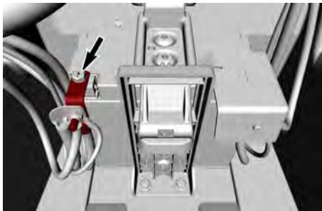
2. Entfernen Sie die zwei Sechskantschrauben und die Unterlegscheiben aus, mit denen die Batteriehalterung an der Unterseite des Batteriefachs befestigt ist.
