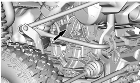
4. Entfernen Sie die zwei Schrauben, mit denen der Getriebeaktor befestigt ist.
