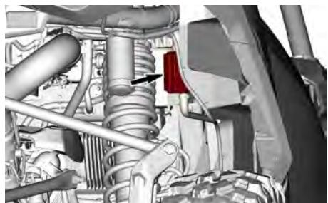
1. Entfernen Sie die Oetiker-Schellen, mit denen die Ein- und Auslassschläuche am Vorfilter befestigt sind.
