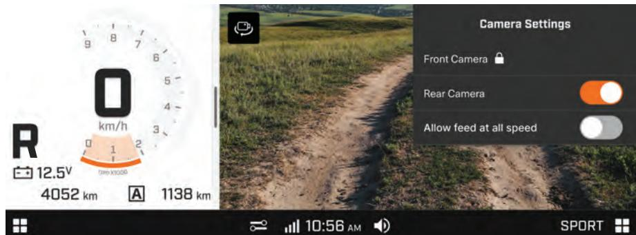
Auf die Kamera kann außerdem über den Touchscreen zugegriffen werden, wenn sich das Fahrzeug nicht im Rückwärtsgang befindet oder der Motor nicht
