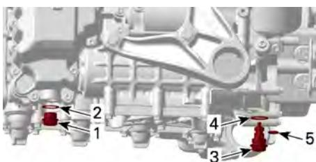
1. Magnetische Ablassschraube für Öltankdeckel
