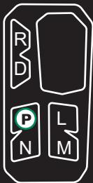
Wählen Sie vor dem Aussteigen aus dem Fahrzeug den Park-Modus (P). Ansonsten kann das Fahrzeug weg rollen. Um den Park-Modus zu aktivieren, betätigen Sie die Bremse und drücken Sie die Taste (P).
