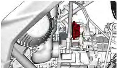
6. Bringen Sie das Werkzeug für die Neutralstellung (befindet sich im Handschuhfach) anstatt des Getriebeaktors an.
