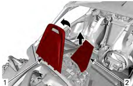
1. Abdeckung des Sicherungskastens
