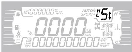
Diese Anzeige zeigt die Getriebestellung an:
