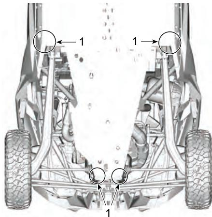
**POSITIONEN, AN DENEN DER HINTERE WAGENHEBER POSITIONIERT WIRD.**
