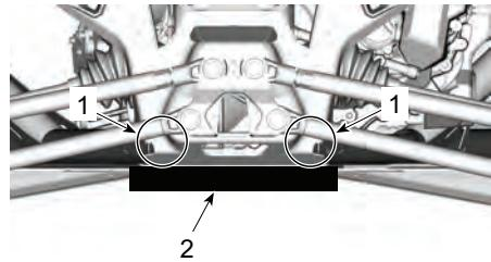
HINTEN ANORDNUNG DES HYDRAULISCHEN WAGENHEBERS
