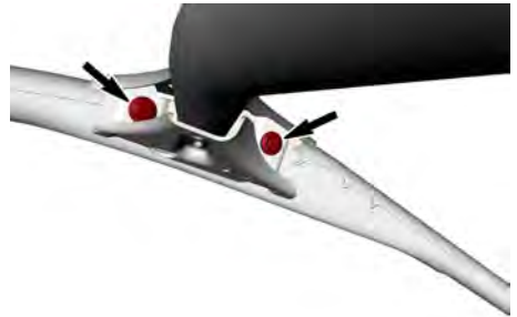
FIXATIONS LATÉRALES AVANT - TYPIQUE
