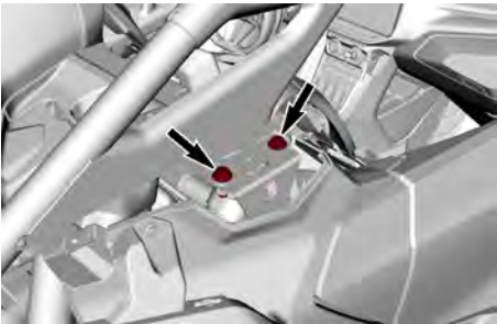
FIXATIONS ARRIÈRE - TYPIQUE
