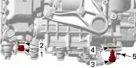
1. Bouchon de vidange magnétique du couvercle du réservoir d'huile
