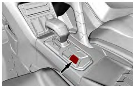
Ce bouton permet de mettre la transmission au Point mort.
