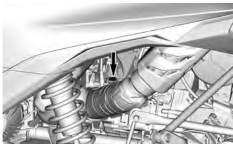
24. Remplissez une seringue avec de l'huile DTC recommandée, voir *Huile recommandée pour la boîte de vitesses DCT*.
