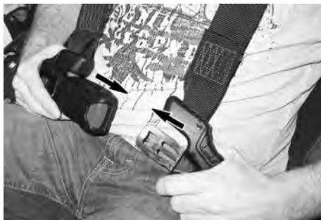
2. Des deux côtés, ajustez la ceinture en l'appuyant fermement sur votre corps en tirant la longueur excédentaire de la ceinture abdominale vers l'intérieur. La boucle doit être centrée à la taille (aussi bas que possible).
