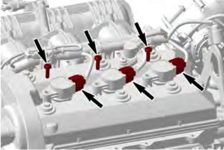
3. Enlevez les bobines d'allumage avec les joints en tournant la bobine d'un côté à l'autre tout en la tirant vers le haut.
