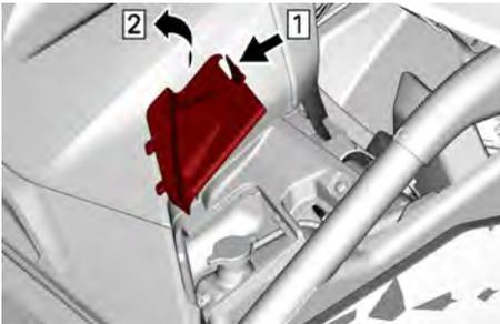
**DÉPOSE DU COUVERCLE D'ENTRETIEN**
