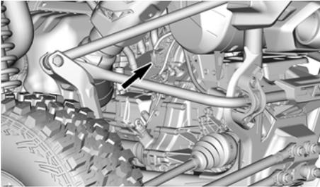
4. Retirez les deux vis qui maintiennent l'actionneur de transmission.
