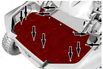
9. Retirez les vis qui maintiennent les déflecteurs acoustiques sur le support du refroidisseur intermédiaire et le châssis. Retirez ensuite le déflecteur de chaque côté du refroidisseur intermédiaire.
