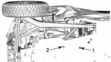
1. Bouchon de vidange magnétique du couvercle de la magnéto
