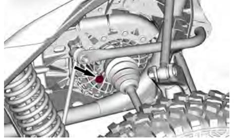
4. Par le dessous du véhicule, à travers le trou de la plaque de protection, nettoyez la zone autour du bouchon de vidange magnétique.
