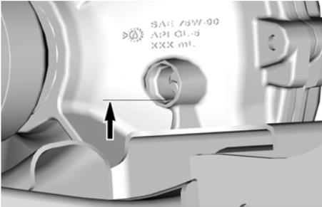
6. Pour ajuster le niveau d'huile, remplissez une seringue avec l'huile recommandée du différentiel avant. Reportez-vous à *Huile du différentiel avant* recommandée.
