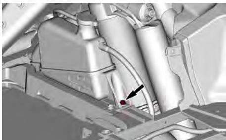
11. Sur le côté gauche, détachez le tuyau d'admission du filtre à air du déflecteur latéral.
