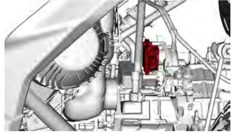
6. Insérez l'outil d'activation du Point mort (situé dans la boîte à gants) à la place de l'actionneur de transmission.
