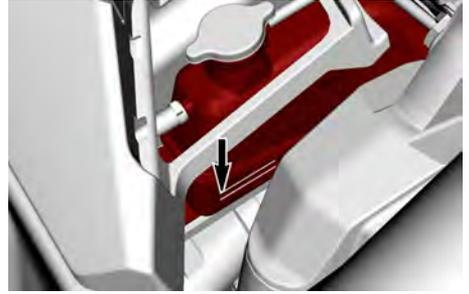
4. Ajoutez du liquide de refroidissement dans le réservoir si nécessaire. Reportez-vous à la section *Remplissage et purge du système de refroidissement*
