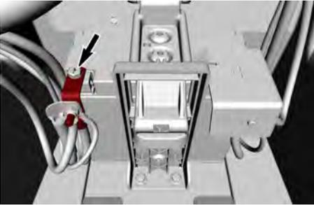
2. Retirez les deux vis à tête hexagonale et les rondelles plates qui fixent le support de batterie au fond de son compartiment.
