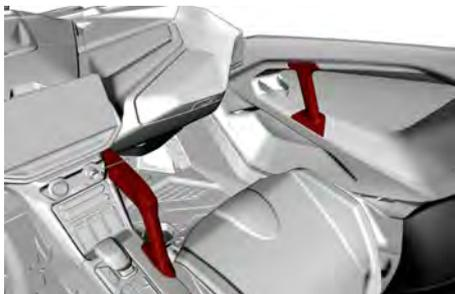
Saisir les poignées de maintien permet aux passagers de s'accrocher pendant le mouvement du véhicule et aide à garder les mains et le corps à l'intérieur de la cabine en cas de renversement.
