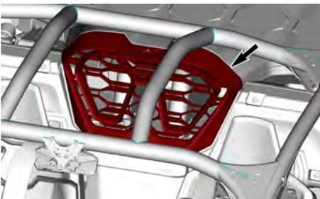
7. Retirez les rivets et les vis en plastique qui fixent l'ensemble d'admission d'air au porte-bagages. Déposez la boîte à air.
