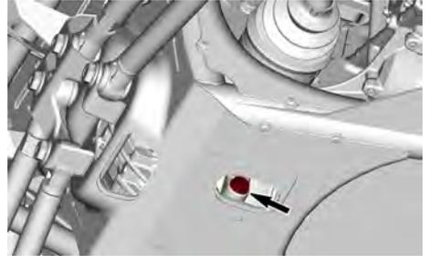
5. Placez un bac de récupération sous le bouchon de vidange magnétique.
