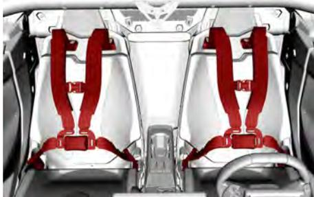
1. Pour attacher la ceinture de sécurité, insérez la languette de verrouillage de la ceinture de sécurité dans la boucle, puis tirez sur la ceinture afin de vous assurer qu'elle est correctement attachée.
