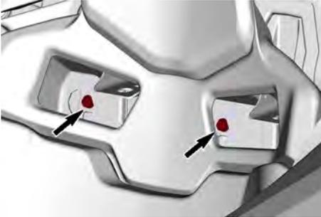
5. Retirez le rivet en plastique situé sur la partie supérieure de la grille d'admission d'air.
