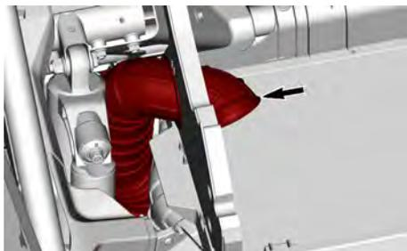
12. Retirez les vis du support du refroidisseur intermédiaire. Retirez ensuite le refroidisseur d'air.
