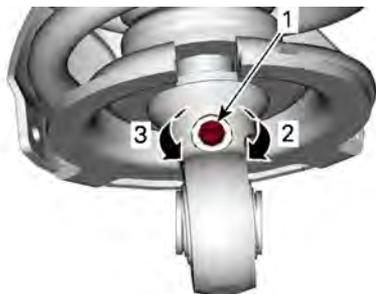
1. Dispositif de réglage de l'amortissement des rebonds
