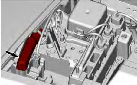
4. Connectez d'abord l'extrémité du câble ROUGE à la borne positive (+) de la batterie à plat.
