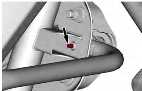
**BARRA ESTABILIZADORA TRASERA - LADO IZQUIERDO - TÍPICA**
