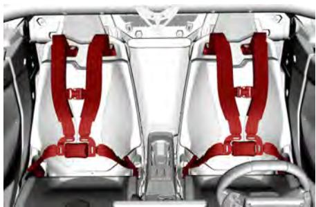
1. Para ajustar el cinturón, inserte la placa de cierre en la hebilla y, después, tire del cinturón para comprobar que está bien asegurado.
