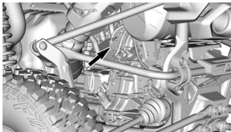
4. Retire los dos tornillos que sujetan el actuador de la transmisión.
