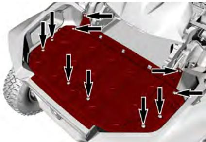
9. Retire los tornillos que sujetan los deflectores acústicos al soporte del intercooler y al chasis. A continuación, retire el deflector de cada lado del intercooler.
