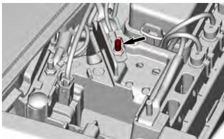
7. Conecte el otro extremo del cable de puente NEGRO al polo negativo (-) de la batería del vehículo de asistencia.
