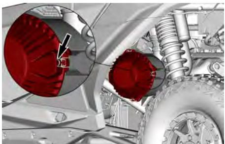
**CLIP DE RETENCIÓN - TÍPICO****REJILLA DELANTERA****Desmontaje de la rejilla delantera**
