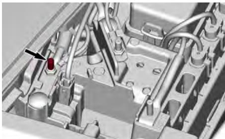
5. A continuación, conecte el otro extremo del cable de puente ROJO al polo positivo (+) de la batería del vehículo de asistencia.
