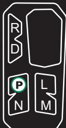
Seleccione el modo de estacionamiento (P) antes de salir del vehículo. El vehículo puede rodar si no se encuentra en la posición de APARCAMIENTO. Para activar el modo de estacionamiento, accione el freno y presione el botón (P).
