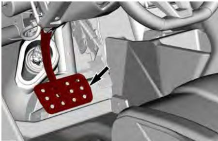
La función del pedal del freno es reducir la velocidad o detener el vehículo.
