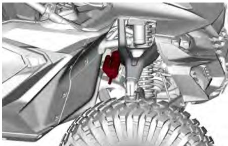
Este amortiguador cuenta con un dial de ajuste que va de 1 (amortiguación ligera) a 3 (amortiguación máxima). Un ajuste más bajo permite un menor esfuerzo al accionar la dirección, ideal para uso ocasional en senderos. Un ajuste más alto aumenta la resistencia de la amortiguación, ideal para condiciones como el ascenso por rocas.
