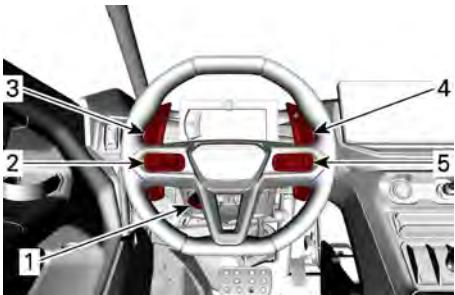
1. Palanca inclinable/telescópica
