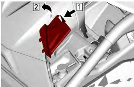
**DESMONTAJE DE LA TAPA DE MANTENIMIENTO**
