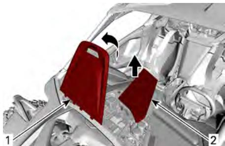
1. Cubierta de la caja de fusibles
