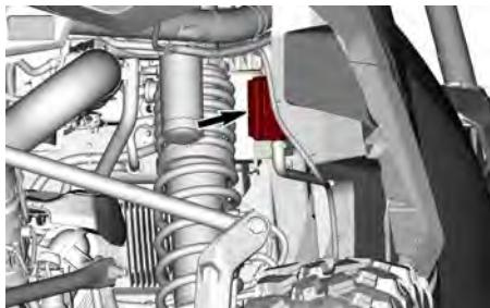
1. Retire las abrazaderas Oetiker que fijan las mangueras de entrada y salida al prefiltro.
