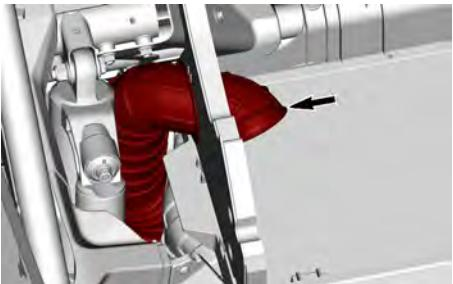
12. Retire los tornillos del soporte del intercooler. A continuación, retire el intercooler.
