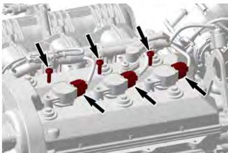
3. Quite las bobinas de encendido con las juntas de la bujía girando la bobina de lado a lado y tirando hacia arriba.
