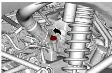
6. Vuelva a insertar la varilla medidora y enrósquela completamente.
