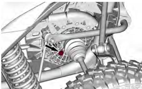
4. Desde debajo del vehículo, a través del orificio de la placa protectora, limpie el área alrededor del tapón de drenaje magnético.
