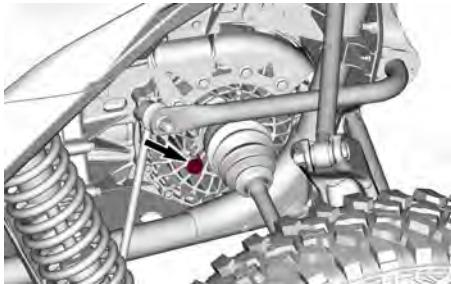
4. Retire el tapón de nivel de aceite de la transmisión final trasera y la junta tórica.
