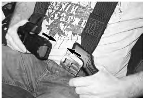
2. En ambos lados, ajuste el cinturón firmemente contra su cuerpo tirando del exceso de cinturón del regazo hacia el interior. La hebilla debe estar centrada en la cintura (lo más baja posible).
