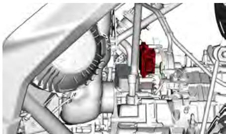
6. Introduzca la herramienta de activación del punto muerto (situada en la guantera) en lugar del actuador de la transmisión.
