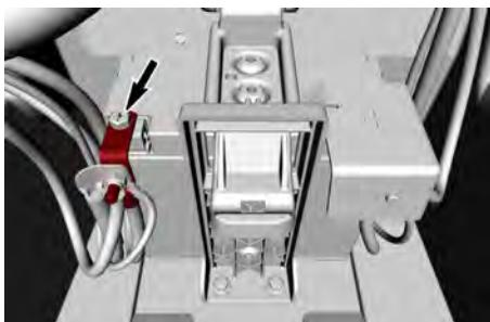
2. Retire los dos tornillos de cabeza hexagonal y las arandelas planas que fijan el soporte de la batería a la parte inferior del compartimento de la batería.
