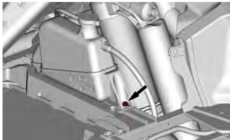
11. En el lado IZQUIERDO, desconecte la manguera de admisión del filtro de aire del deflector lateral.
