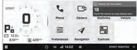
La pantalla táctil se mantiene EN-CENDIDA durante una hora después de la última interacción con la pantalla táctil o hasta que el nivel de la batería baje a 11.8 V.
