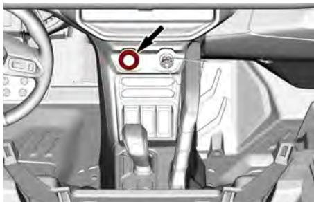
Con la llave D.E.S.S. insertada, mantenga presionado el botón ARRANQUE/PARADA DEL MOTOR para arrancar el motor.
