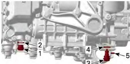
1. Tapón de drenaje magnético de la tapa del depósito de aceite
