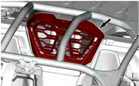
7. Retire los remaches de plástico y los tornillos que fijan el conjunto de la toma de aire al portaequipajes. A continuación, retire el conjunto de la toma de aire.
