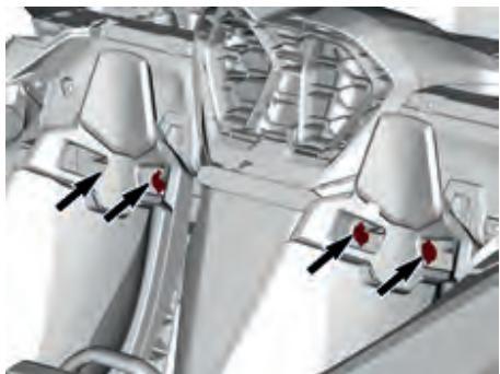
4. Retire los cuatro tornillos, dos detrás de cada asiento, que fijan el soporte del intercooler al tabique central trasero.
