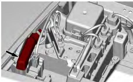
4. Empiece conectando un extremo del cable de puente ROJO al polo positivo (+) de la batería descargada.
