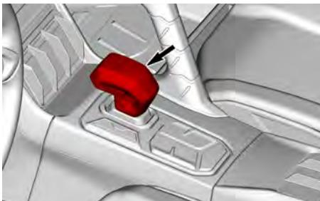
La palanca se utiliza para poner la transmisión en REVERSA o AVANCE.
