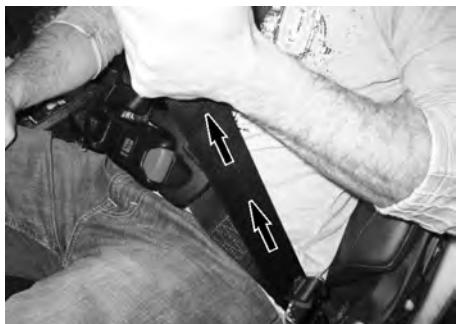
3. Para aflojar el cinturón, sujeté el cinturón del regazo con una mano y tire de la correa roja hacia afuera.
