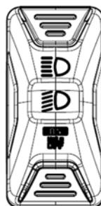
Este interruptor se utiliza para seleccionar las luces bajas o altas de los faros.
