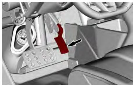
El pedal del acelerador controla la velocidad y la aceleración del vehículo.
