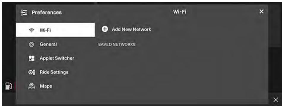
Si no hay una red Wi-Fi disponible cerca del vehículo, puede compartir la red celular de su teléfono inteligente mediante un punto de acceso. Solo tenga en cuenta que pueden aplicarse tarifas de datos celulares. La pantalla táctil de 10.25" solo se conecta a una red segura.
