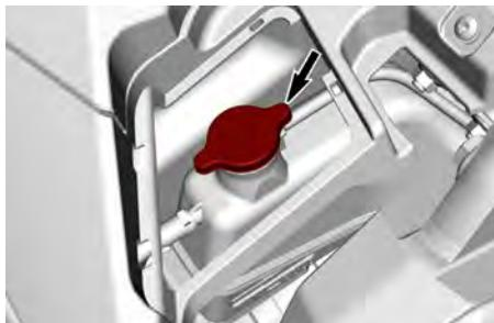
2. Añada refrigerante hasta que el nivel llegue a la línea MAX del depósito de refrigerante. Consulte *Refrigerante recomendado para el motor*. Utilice un embudo para evitar que se derrame. **No llene excesivamente.**
