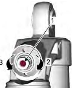
**AMORTIGUACIÓN DE COMPRESIÓN A VELOCIDAD BAJA (UTILICE UN DESTORNILLADOR)**
