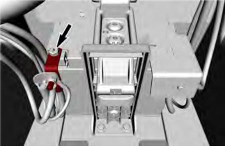
2. Remova os dois parafusos sextavados e as arruelas planas que prendem o suporte da bateria na parte inferior do compartimento da bateria.
