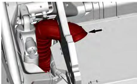
12. Remova os parafusos do suporte do intercooler. Depois, remova o intercooler.
