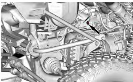
4. Insira a chave Torx T30 (localizada no kit de ferramentas do veículo) no final do eixo da alavanca de transmissão, através do orifício de acesso.
