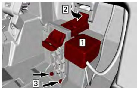
1. Coloque a tampa do terminal positivo
