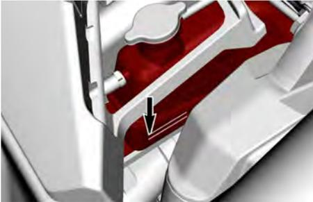
4. Adicione líquido de arrefecimento no reservatório conforme necessário. Consulte *Reabastecimento e sangria do sistema de arrefecimento*
