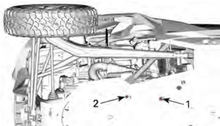
1. Bujão de drenagem magnético da tampa do magneto
