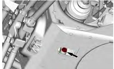
5. Coloque um recipiente de drenagem sob a área do bujão de drenagem magnético.
