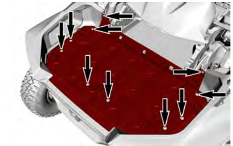
9. Remova os parafusos que prendem os defletores acústicos no suporte do intercooler e no chassi. Depois, remova o defletor de cada lado do intercooler.
