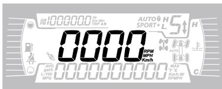
Exibe a velocidade do veículo em km/h ou MPH/RPM.
