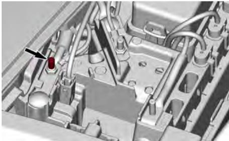
5. Em seguida, ligue a outra ponta do cabo auxiliar VERMELHO ao polo positivo (+) da bateria do outro veículo.
