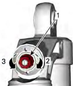
**AMORTECIMENTO POR COMPRESSÃO EM ALTA VELOCIDADE (USE UMA CHAVE INGLESA DE 17 MM)**
