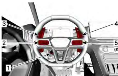
1. Alavanca de inclinação/telescópica
