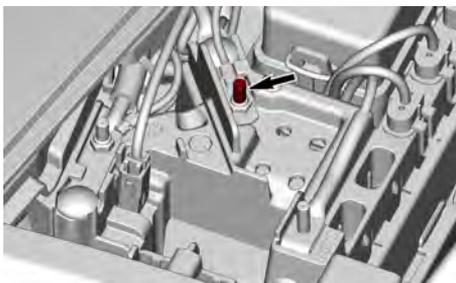
7. Conecte a outra extremidade da ponta auxiliar PRETA ao polo negativo (-) da bateria do outro veículo.
