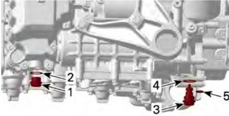
1. Bujão de drenagem magnético da tampa do tanque de óleo
