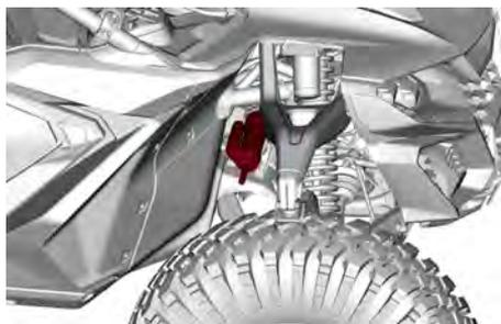
Esse amortecedor possui um seletor de configuração ajustável pelo usuário que varia de 1 (amortecimento leve) a 3 (amortecimento máximo). Uma configuração mais baixa permite um esforço de direção mais leve, sendo adequada para uso casual em trilhas. Uma configuração mais alta aumenta a resistência do amortecimento, ideal para condições como pilotar sobre rochas.
