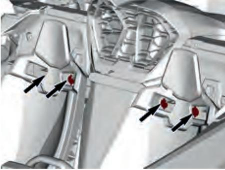
4. Remova os quatro parafusos, dois atrás de cada assento, que prendem o suporte do intercooler na parte central superior.
