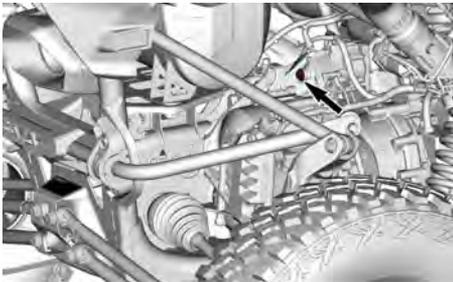
4. Insérez la clé Torx T30 (située dans la trousse à outils du véhicule) dans l'extrémité de l'axe du sélecteur de vitesses par le trou d'accès.
