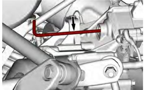
5. Tournez la clé Torx T30 vers le côté conducteur (gauche du véhicule) jusqu'à ce qu'elle s'arrête.
