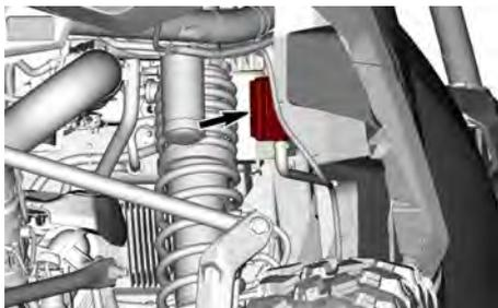
1. Retirez les colliers Oetiker qui fixent les tuyaux d'entrée et de sortie sur le pré-filtre.
