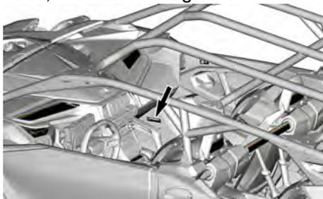
Le numéro d'identification du véhicule est aussi gravé sur son châssis.
