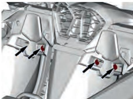
4. Retirez les quatre vis, deux derrière chaque siège, qui fixent le
