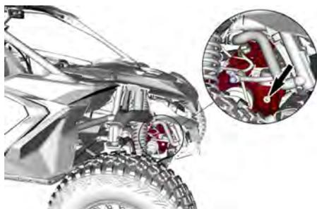
4. Retirez le bouchon de niveau d'huile et le joint torique.
