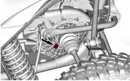
4. Retirez le bouchon de niveau d'huile de la transmission finale et le joint torique.
