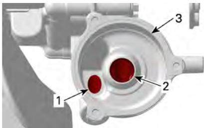
1. Orifice d'entrée de l'huile sous pression refoulée par la pompe à huile
