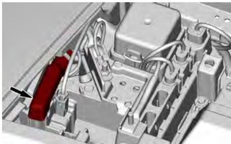
4. Connectez d'abord l'extrémité du câble ROUGE à la borne positive (+) de la batterie à plat.
