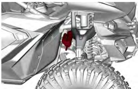
Cet amortisseur est équipé d'un cadran de réglage réglable par l'utilisateur allant de 1 (amortissement léger) à 3 (amortissement maximal). Un réglage plus bas permet un effort de direction plus léger, ce qui convient à une utilisation occasionnelle sur piste. Un réglage plus élevé augmente la résistance à l'amortissement, ce qui est idéal pour des conditions telles que la conduite sur rochers.
