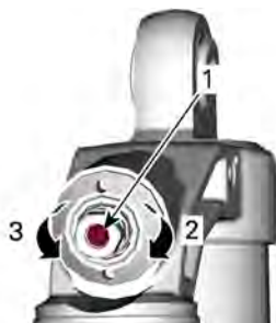
AMORTIGUACIÓN DE COMPRESIÓN A VELOCIDAD BAJA (UTILICE UN DESTORNILLADOR)
