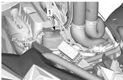
1. Serbatoio liquido refrigerante motore
