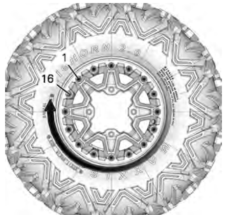
TYPIQUE - SÉQUENCE DE SERRAGE FINAL
