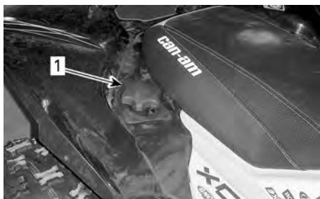
1. 油箱加注口盖
