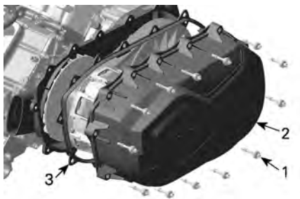
1. CVT-kåpskruv 2. CVT-kåpa 3. Packning
