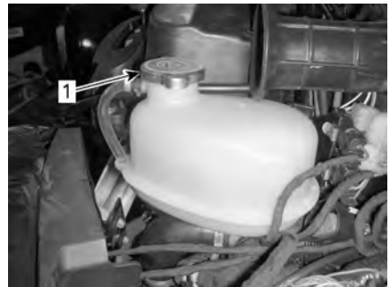
1. Løkk for kjølevæskebeholder
