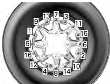
TYPISCH - AANDRAAIVOLGORDE
