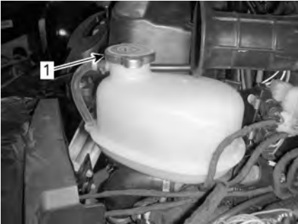
1. Tapón del depósito de refrigerante del motor
