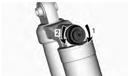
AMORTIGUACIÓN DE COMPRESIÓN - PARTE SUPERIOR DEL AMORTIGUADOR
