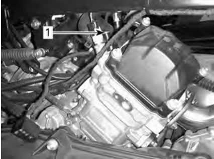
1. Tornillo de purga del cilindro trasero
