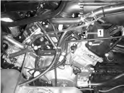
1. Tornillo de purga del cilindro delantero
