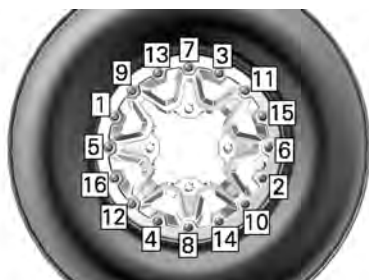
SITUAZIONE TIPICA - SEQUENZA DI SERRAGGIO
