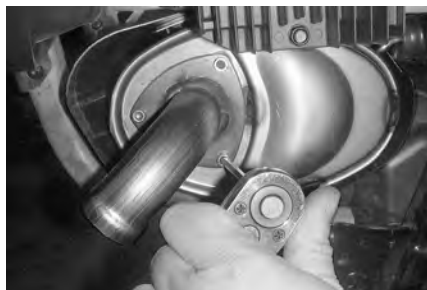
CONFIGURAZIONE TIPICA - RIMUOVERE IL TUBO DI CODA
