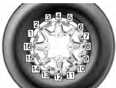
TYPIQUE - SÉQUENCE DE SERRAGE FINAL
