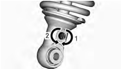
AMORTISSEMENT DES REBONDS - DESSOUS DE L'AMORTISSEUR
