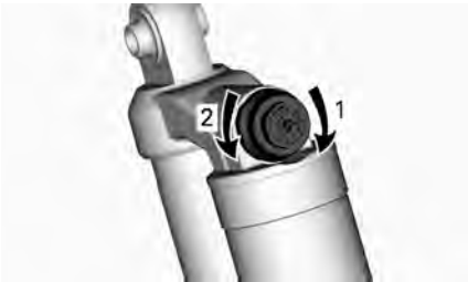
AMORTISSEMENT DE COMPRESSION - DESSUS DE L'AMORTISSEUR
