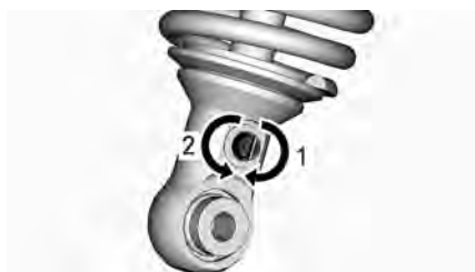
AMORTIGUACIÓN DE REBOTE - PARTE INFERIOR DEL AMORTIGUADOR
