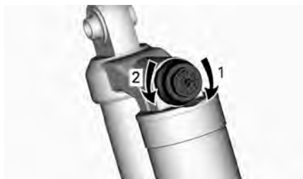
AMORTIGUACIÓN DE COMPRESIÓN - PARTE SUPERIOR DEL AMORTIGUADOR
