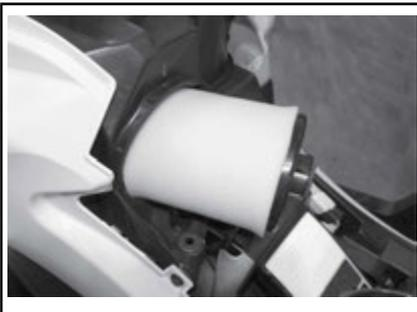
**RIMOZIONE DEL FILTRO DELL'ARIA**
