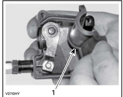
1. Protezione interna dell'alloggiamento
