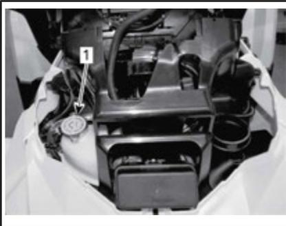
1. Tappo del serbatoio liquido refrigerante motore
