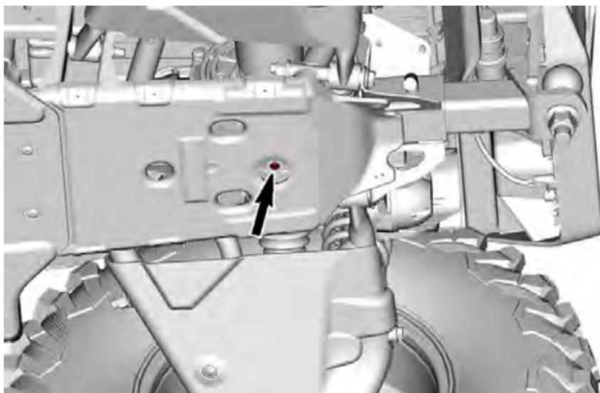
5. Stellen Sie eine Ablaufwanne unter das Hinterachsgetriebe.
