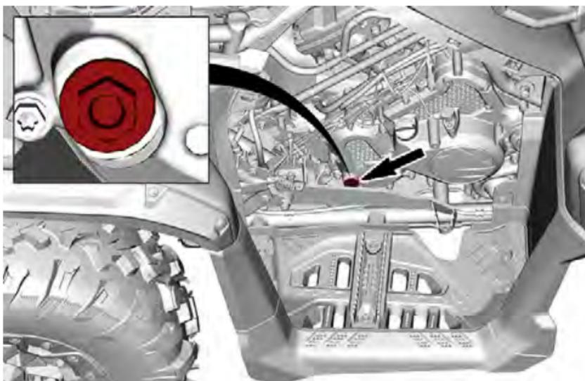
7. Lassen Sie das Öl vollständig aus dem Getriebe ablaufen.
