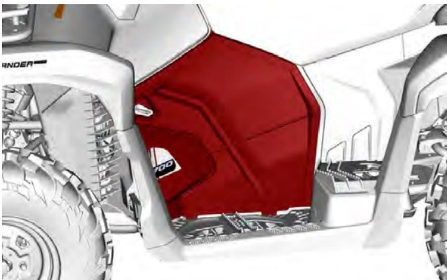
2. Entfernen Sie den linken inneren Kotflügel vorn.
