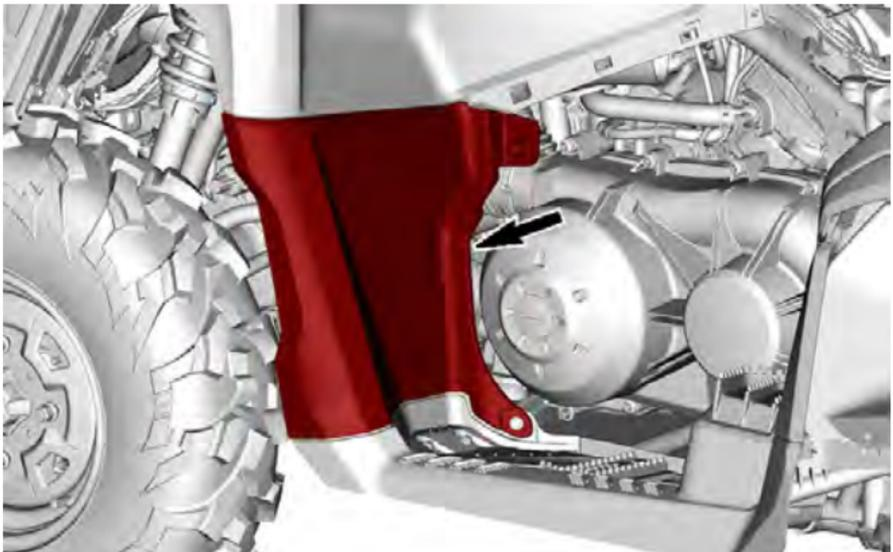
4. Ziehen Sie den Kühllufteinlassschlauch von der CVT-Abdeckung ab.
