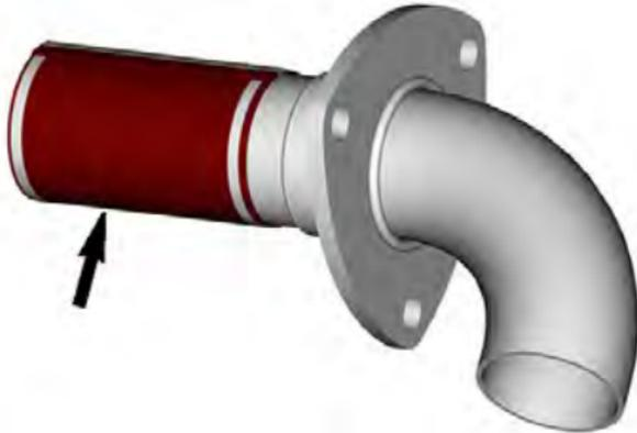
4. Reinigen Sie Flansche des Auspufftopfs und des Funkenfängers von Dichtungsresten.
