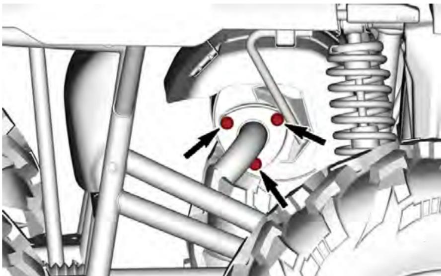
2. Entfernen Sie das Auspuffrohr und entsorgen Sie die Dichtung.
