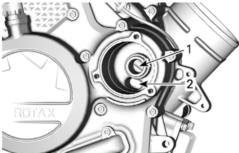
1. Auslass-Bohrung zur Ölspeisung des Motors
