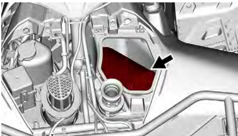
3. Setzen Sie zuerst die vorderen Zungen der Luftfilterabdeckung ein.
