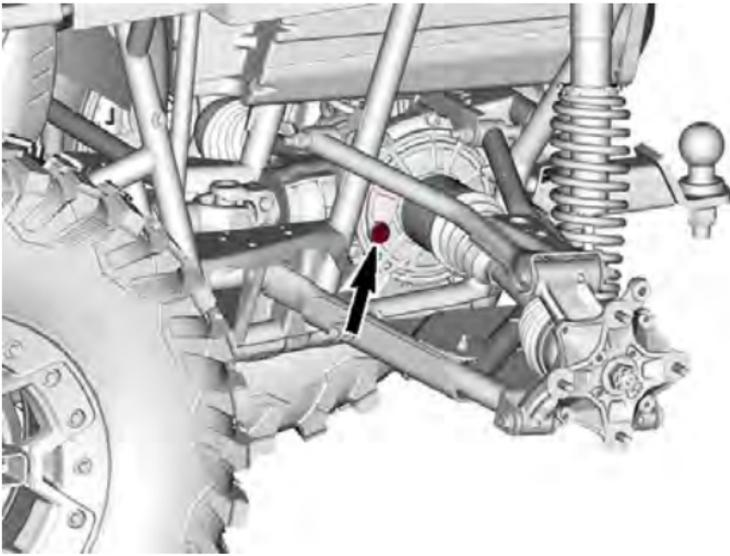
5. Entfernen Sie den Einfüllstopfen.
