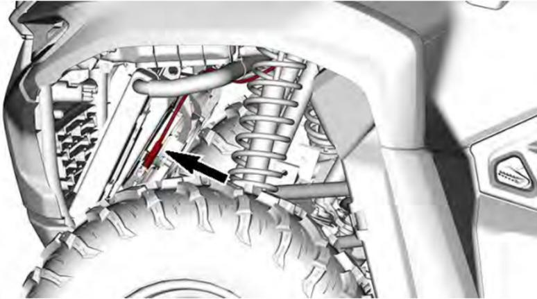
3. Ziehen Sie den Kühlerlüfter zur linken Seite des Fahrzeugs.
