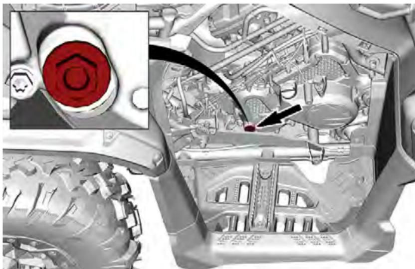
5. Ölfüllstand überprüfen. Das Öl muss bis zur Unterkante der Ölfüllstandsöffnung reichen.
