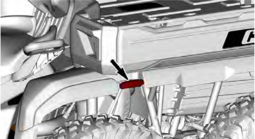
Um das Öffnen der Transportbox zu erleichtern, drücken Sie die Ecke der Transportbox nach unten, während Sie den Entriegelungsgriff nach oben bewegen.
