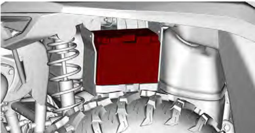
2. Die Batterie mit dem Halteriemensichern.
