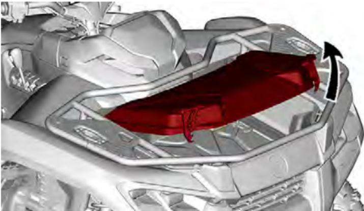
2. Drehen Sie den Hebel im Staufach, um die Abdeckung in der Offen-Stellung zu verriegeln.
