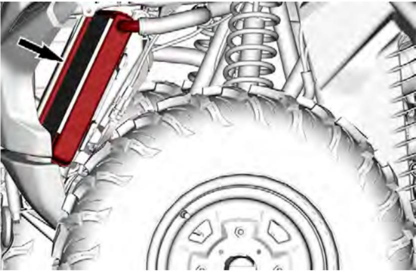
1. Demontieren Sie beide vorderen Luftabweiser an jeder Seite des Kühlers.
