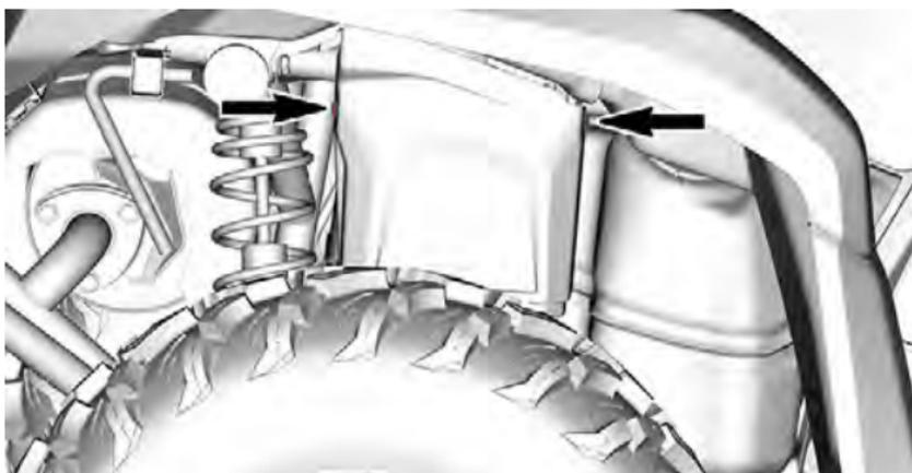
2. Entfernen Sie die Batterieabdeckung.
