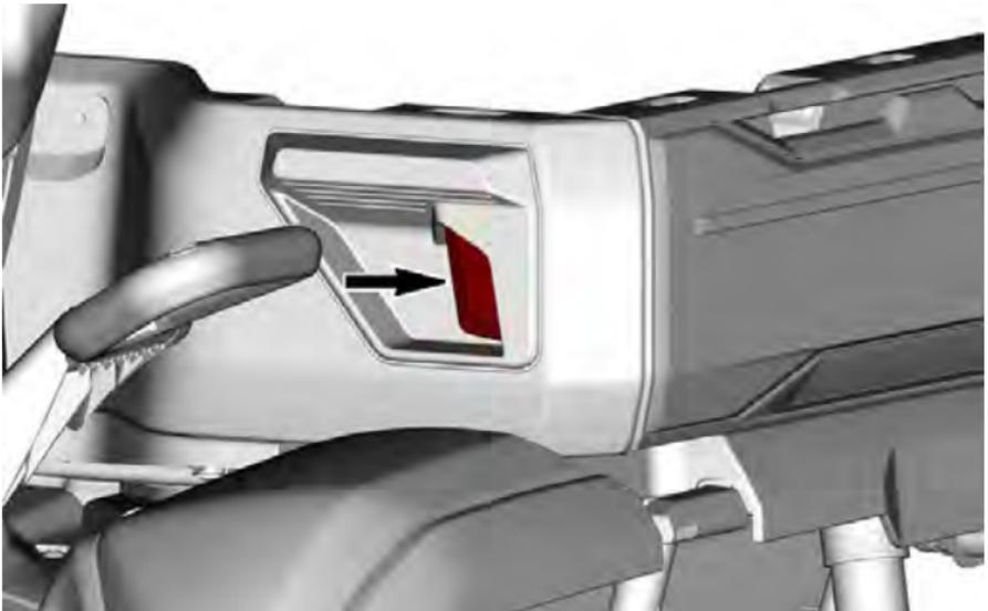
4. Halten Sie den vorderen Griff fest und bewegen Sie die Wand nach hinten, bis der vordere Haltehaken sichtbar wird.
