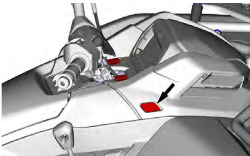
3. Sganciare entrambe le linguette di bloccaggio ai lati dello sterzo.
