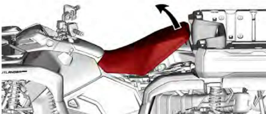
3. Continuare a tirare fino a sganciare il dispositivo di fissaggio anteriore, quindi rimuovere il sedile.
