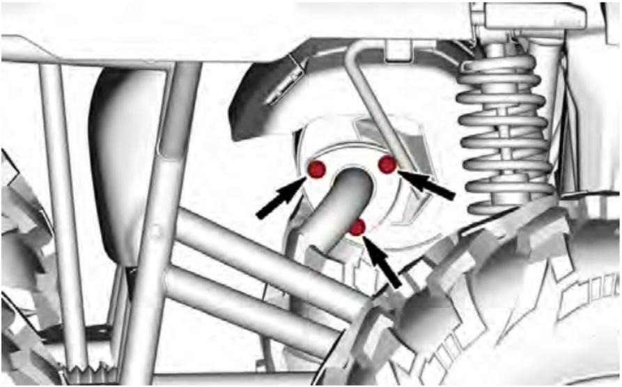
2. Rimuovere il tubo di uscita dello scarico ed eliminare la guarnizione.
