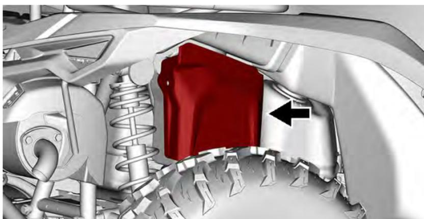
6. Fissare il coperchio della batteria con i rivetti in plastica precedentemente rimossi.
