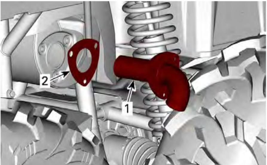
1. Tubo di uscita di scarico con parascintille
