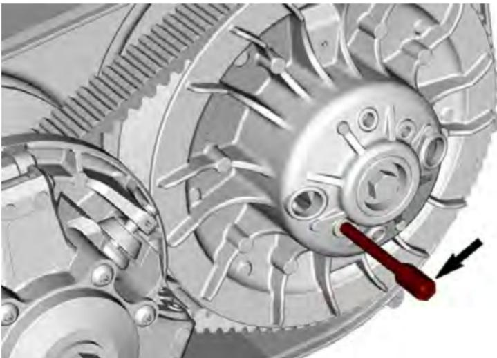
4. Ruotare la puleggia condotta fino a quando la parte più bassa degli ingranaggi che si trovano sulla superficie esterna della cinghia di trasmissione è a livello con il bordo della puleggia condotta.
