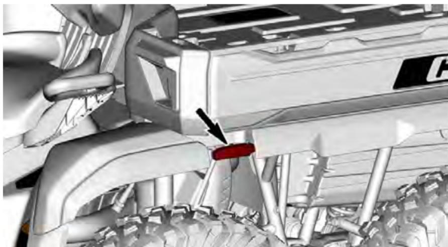
Per facilitare l'apertura del vano di carico, premere verso il basso l'angolo del vano di carico mentre si sposta la maniglia di sblocco verso l'alto.
