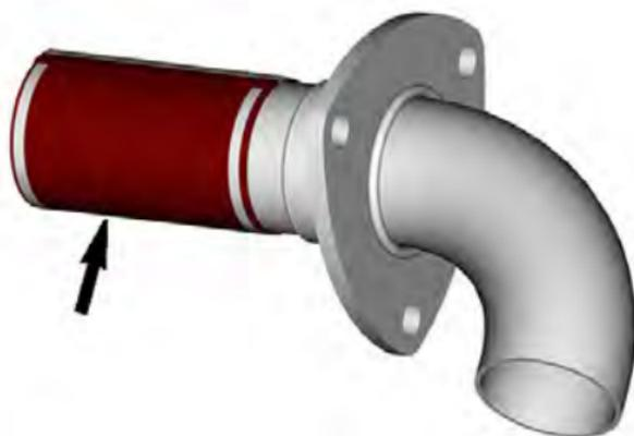
4. Pulire le flange del silenziatore e del parascintille dai residui della guarnizione.
