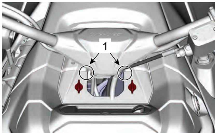
1. Posizione della linguetta di bloccaggio
