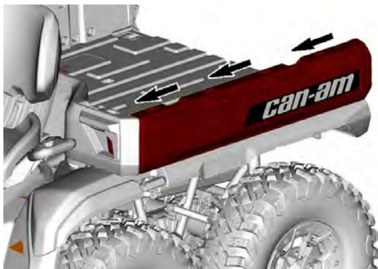
3. Bloccare in posizione la sponda laterale abbassando il blocco posteriore.
