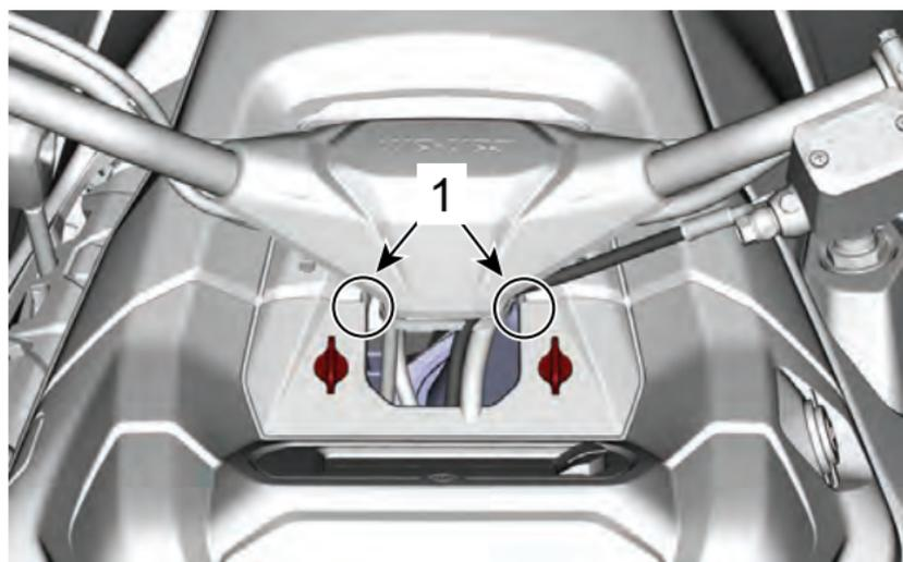
1. Posizione della linguetta di bloccaggio
