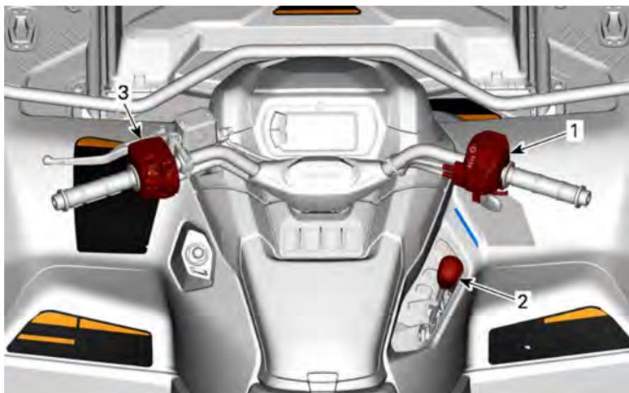
1. Alloggiamento del comando della leva dell'acceleratore
