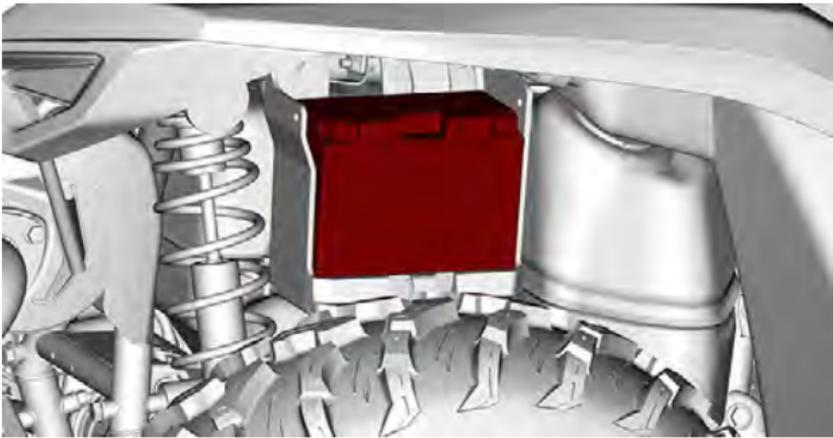
2. Fissare la batteria con la cinghia di attacco della batteria.
