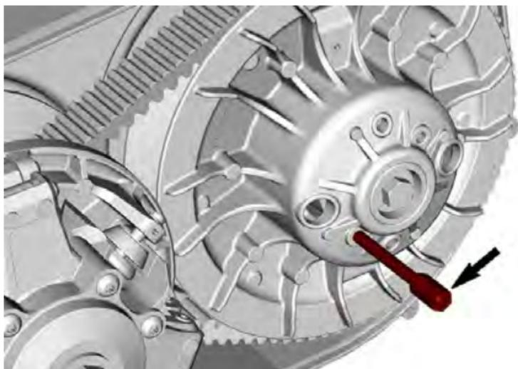
4. Drehen Sie die angetriebene Riemenscheibe, bis der unterste Teil der Zahnräder auf der Außenfläche des Antriebsriemens bündig mit der Kante der angetriebenen Riemenscheibe abschließt.
