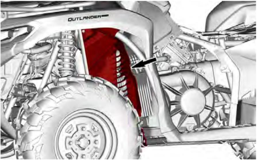
3. Entfernen Sie die linke vordere Fußstütze.
