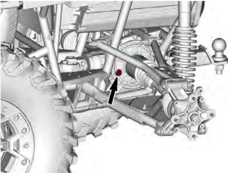
8. Entfernen Sie den Einfüllstopfen.
