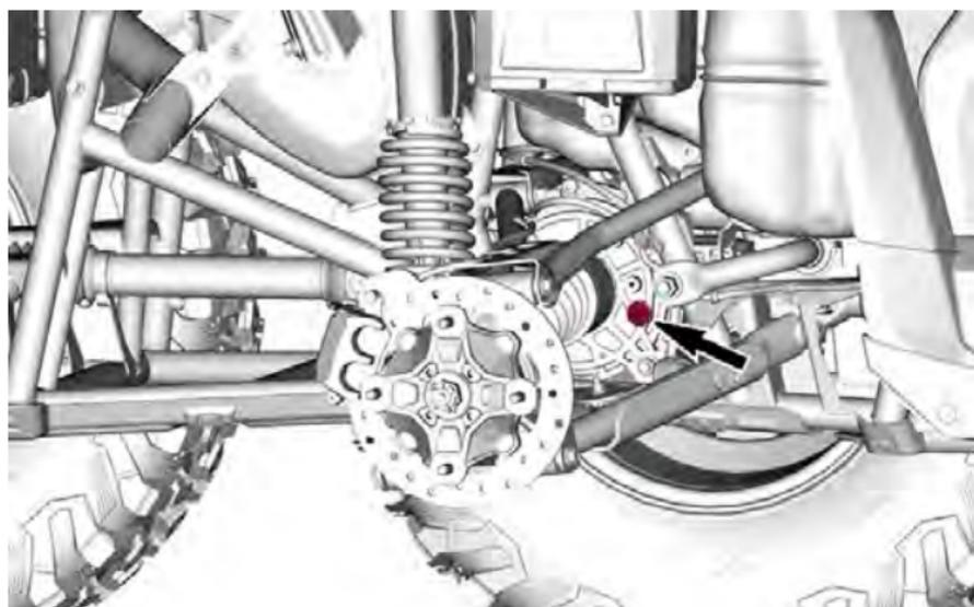
5. Entfernen Sie den Einfüllstopfen.
