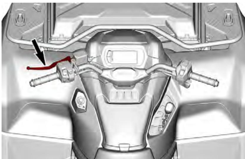
Mit dem Bremshebel wird das Fahrzeug abgebremst oder zum Stillstand gebracht.
