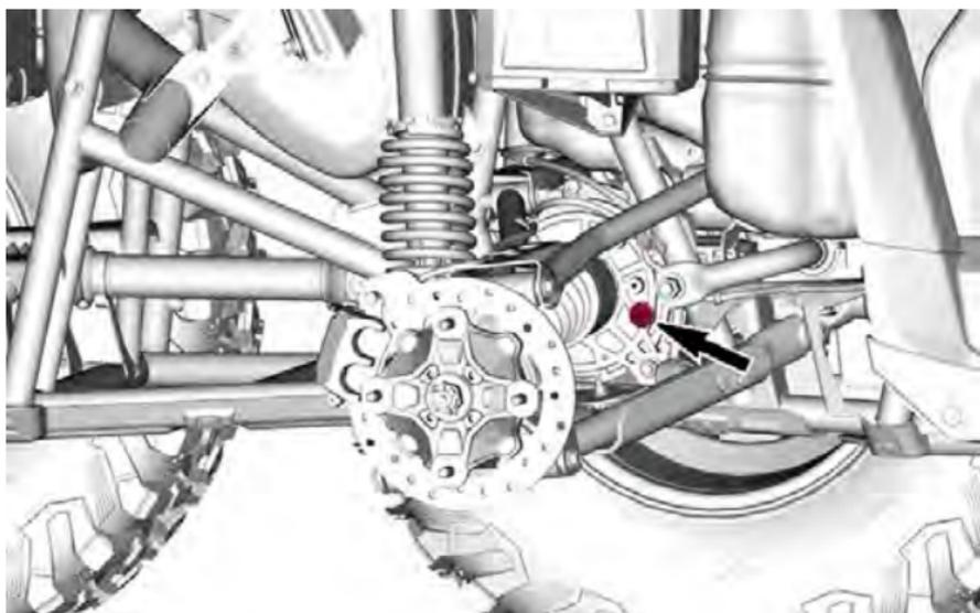
8. Entfernen Sie den Einfüllstopfen.
