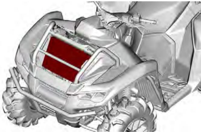
2. Inspeccione o radiador e as mangueiras quanto a vazamentos e danos.
