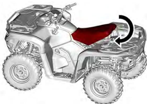
4. Verifique de novo se o assento está instalado firmemente, puxando com força a parte dianteira para confirmar que está devidamente travado.
