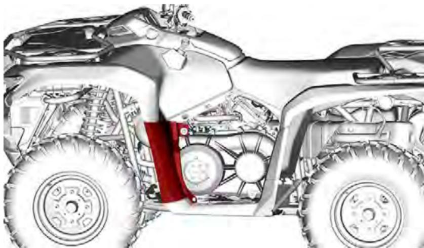
4. Desconecte o duto de refrigeração do ar de entrada da tampa da CVT.
