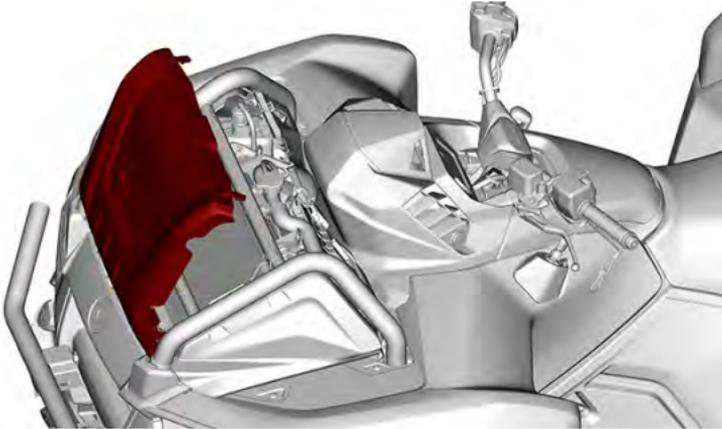
2. Com o veículo em uma superfície nivelada, o líquido deve estar entre as marcas de nível MÍN. e MÁX. do reservatório do líquido de arrefecimento.
