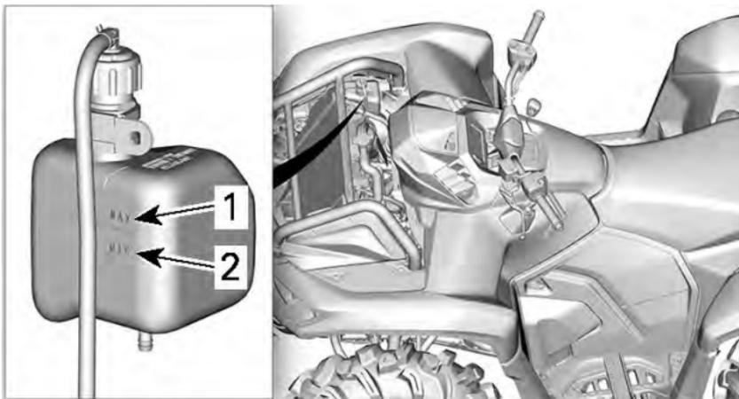
Para acrescentar líquido de arrefecimento no sistema, remova a tampa de pressão do líquido de arrefecimento.
