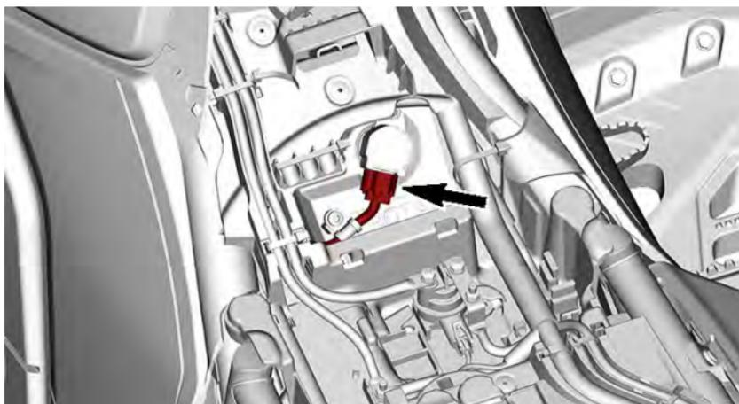
3. Retire a bobina de ignição.
