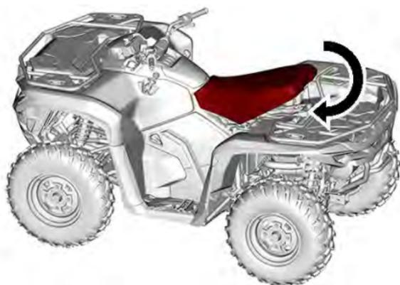
4. Controllare ripetutamente che il sedile sia fissato dando uno strattone e tirando la parte anteriore per verificare che sia correttamente bloccato.
