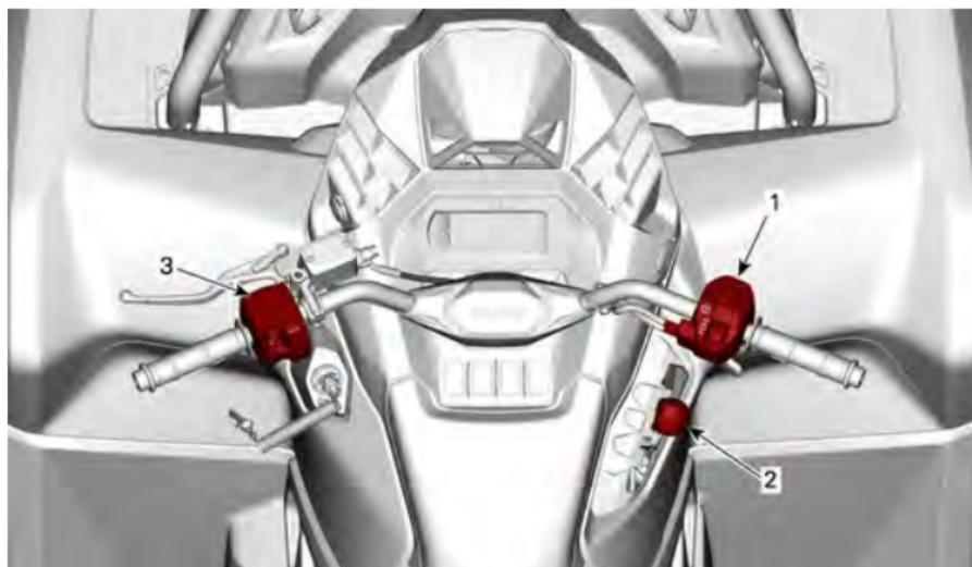
1. *Alloggiamento del comando della leva dell'acceleratore*
