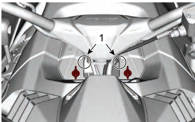
1. Posizione della linguetta di bloccaggio
