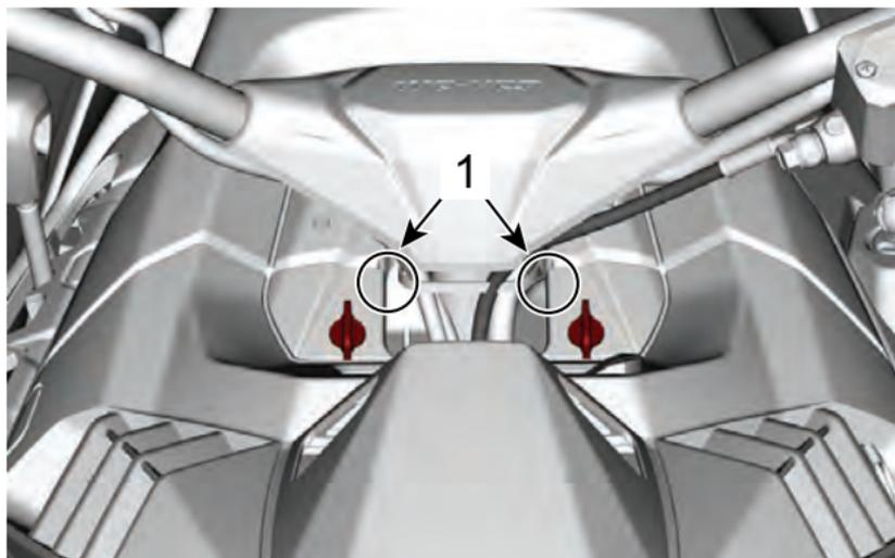
1. Posizione della linguetta di bloccaggio
