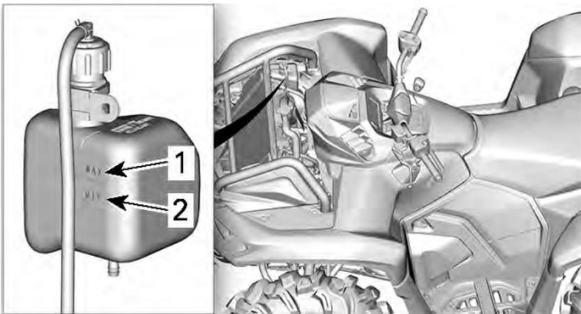
Per aggiungere liquido refrigerante nel sistema, rimuovere il tappo di pressione del sistema di raffreddamento.
