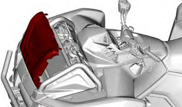
2. Se il veicolo si trova su una superficie piana, il livello del liquido dovrebbe essere compreso tra le tacche di MIN e MAX del serbatoio liquido refrigerante.
