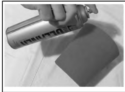
TÍPICO - ROCÍE EL FILTRO DE ESPUMA.
