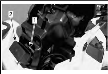
1. Caja de fusibles delantera 2. Tapa de la caja de fusibles delantera
