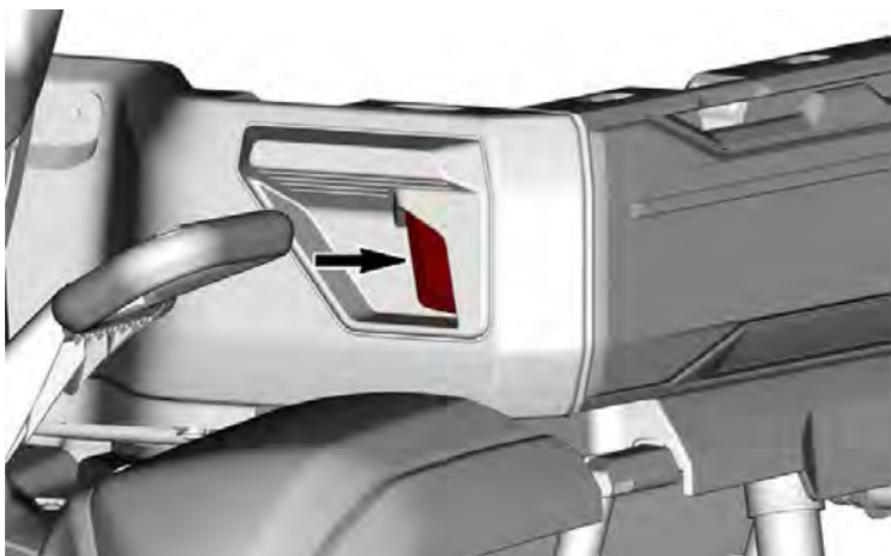
4. Halten Sie den vorderen Griff fest und bewegen Sie die Wand nach hinten, bis der vordere Haltehaken sichtbar wird.
