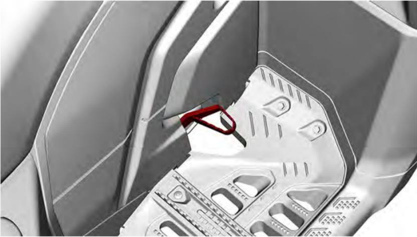
Wenn das Bremspedal betätigt wird, wird die hintere Bremse wirksam.
