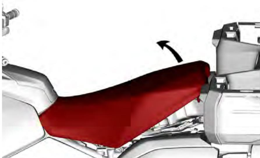
4. Ziehen Sie den Sitz nach hinten, um die vordere Befestigungslasche zu lösen, und nehmen Sie dann den Sitz vollständig heraus.
