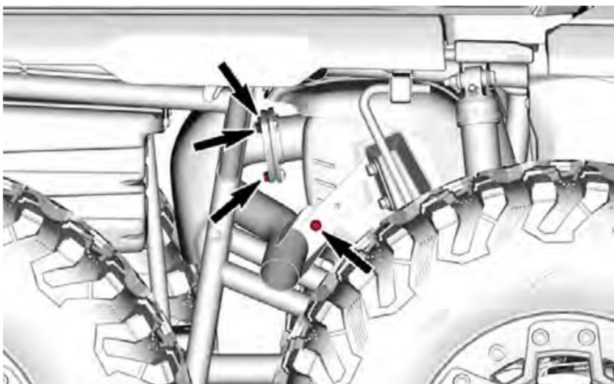
2. Drehen und entfernen Sie das Auspuffrohr.
