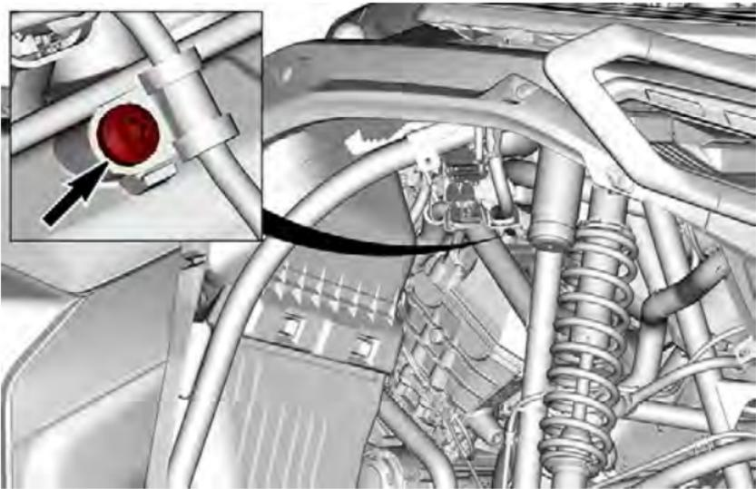
6. Ziehen Sie den Zündspulen-Steckverbinder ab.
