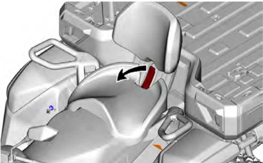
2. Bei nach vorne gedrücktem Verriegelungshebel drücken Sie die Rückseite des Verriegelungshebels nach unten, um den hinteren Hebel vom Stift zu lösen und drücken den Sitz mithilfe der Rückenlehne nach vorne.
