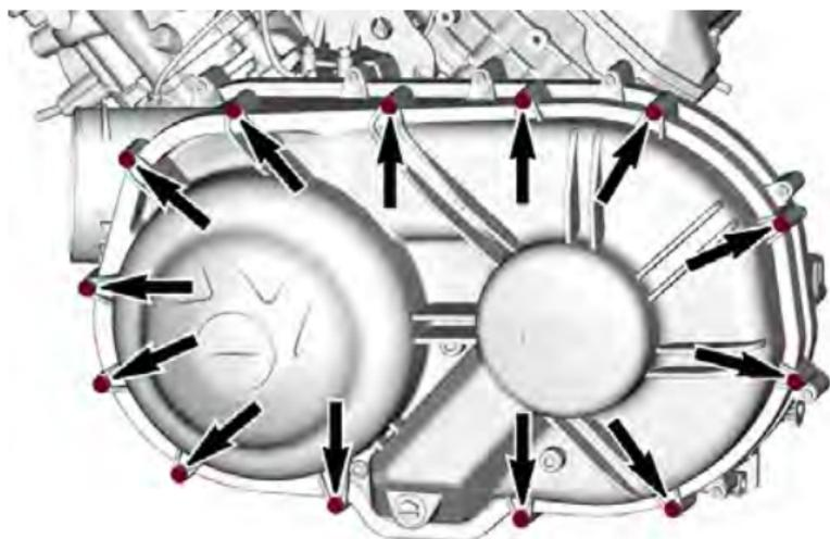
**Tipp:** Entfernen Sie die mittlere obere Schraube zuletzt, um die Abdeckung während des Ausbaus abzustützen.
