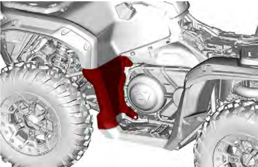
4. Ziehen Sie den Kühllufteinlassschlauch von der CVT-Abdeckung ab.
