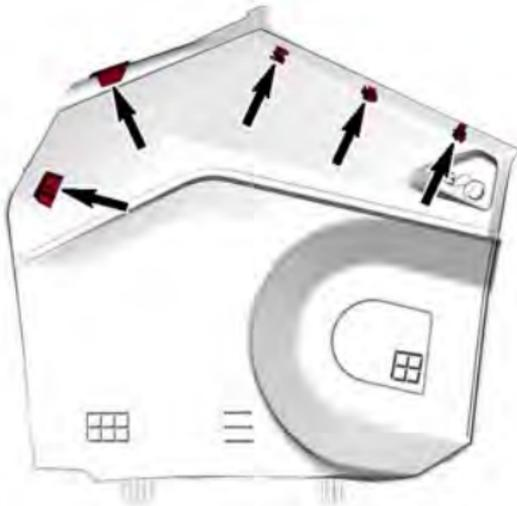
4. Neigen Sie die Seitenverkleidung zur Fahrzeugaußenseite und ziehen Sie sie nach oben aus, um sie vom Fahrzeug zu entfernen.
