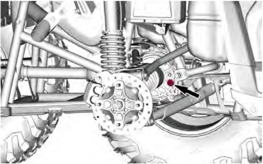
8. Entfernen Sie den Einfüllstopfen.
