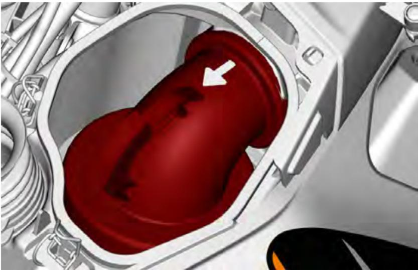
6. Ziehen Sie den Luftfilteradapter und den Luftfilter vorsichtig aus dem Luftfiltergehäuse.
