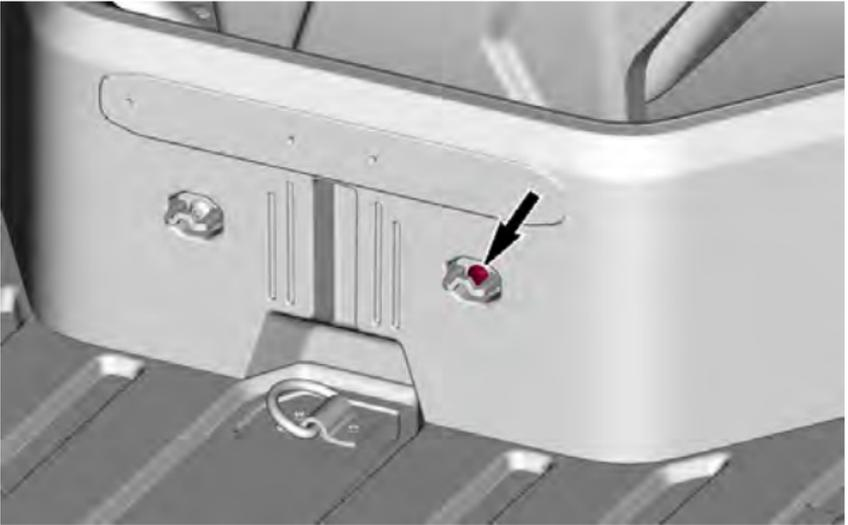
2. Entfernen Sie den Haken und setzen Sie die Schraube und die Unterlegscheibe wieder ein.
