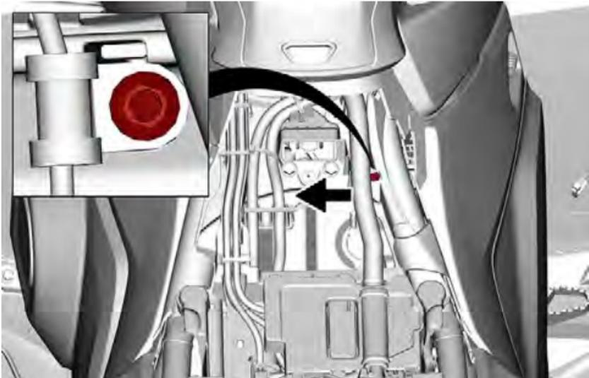
4. Ziehen Sie den Zündspulen-Steckverbinder ab.
