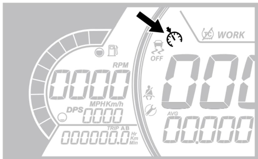
Durch Aktivieren des Geschwindigkeitsbegrenzungsmodus wird nur die verfügbare Höchstgeschwindigkeit beim Betätigen des Gaspedals beschränkt.
