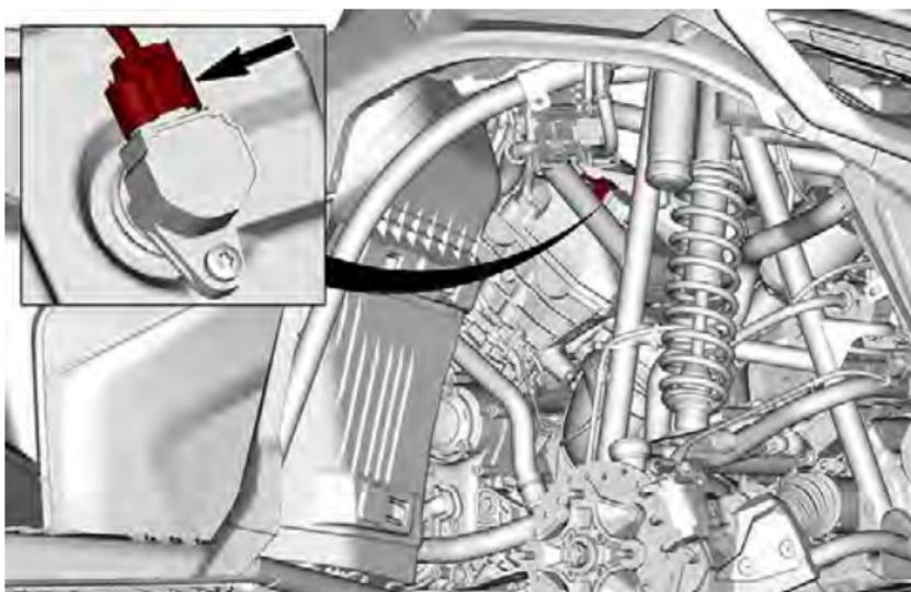
6. Montieren Sie die Schraube der Zündspulenklemme.
