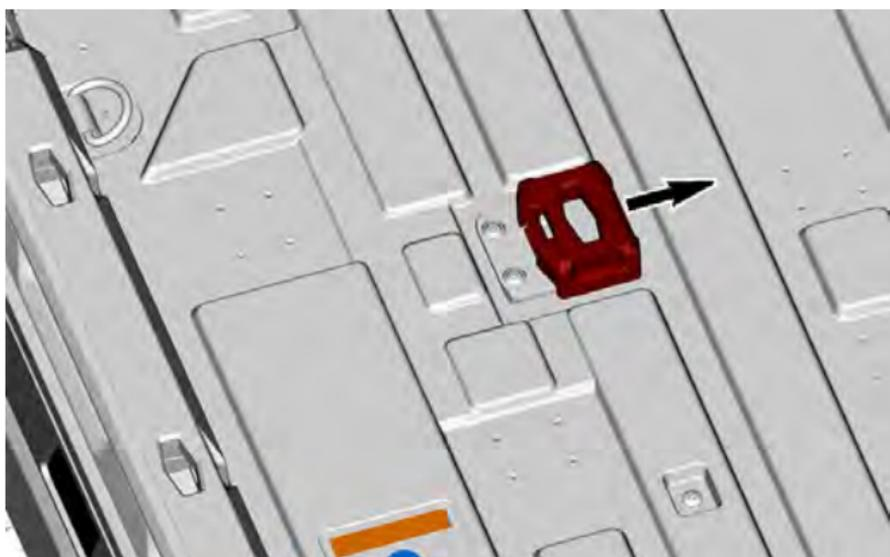
3. Wenn beide LinQ-Befestigungen entfernt sind, heben Sie die Transportbox an.
