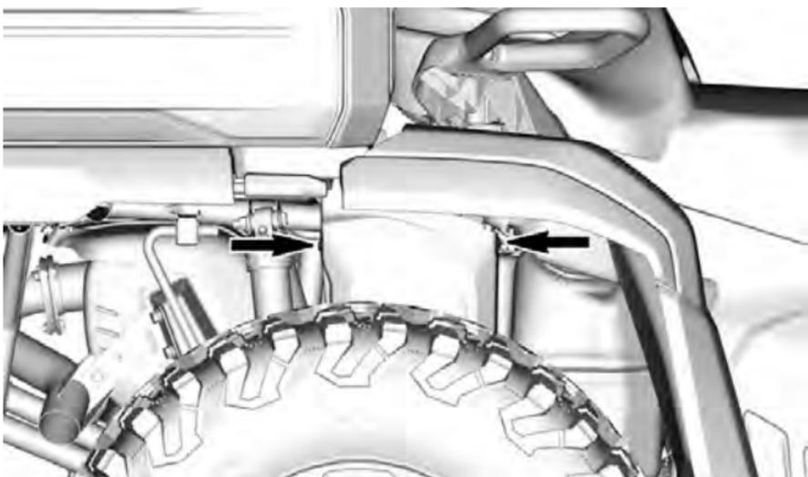
2. Entfernen Sie die Batterieabdeckung.
