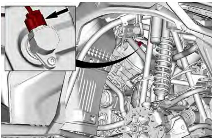
7. Entfernen Sie die Befestigungsschraube der Zündspule.
