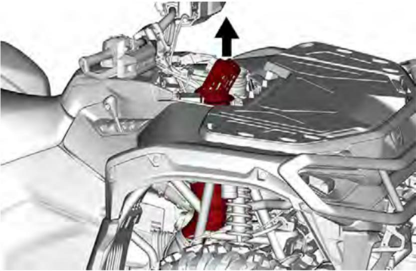
5. Entfernen Sie die Schraube der Zündspulenkerle.
