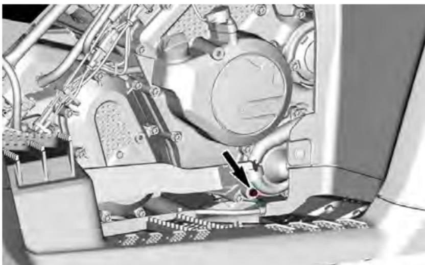
3. Zum Schluss lösen Sie den unteren Kühlerschlauch von der Abdeckung der Wasserpumpe und lassen Sie das übrige Kühlmittel in einen geeigneten Behälter ablaufen. Rangieren Sie die Oetiker-Schelle aus.
