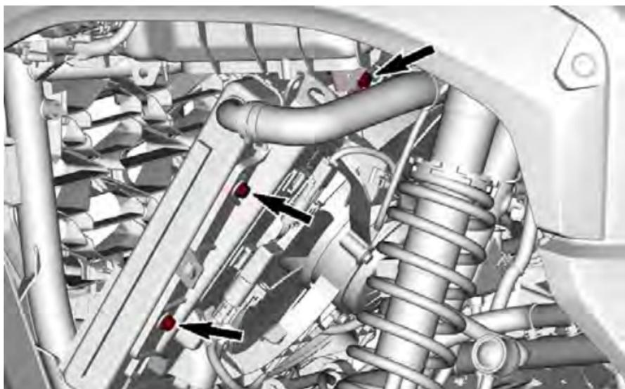
4. Ziehen Sie den Kühlerlüfter zur linken Seite des Fahrzeugs.
