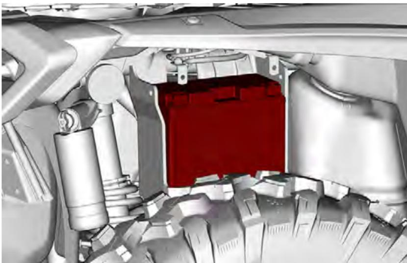
2. Die Batterie mit dem Halteriemens sichern.
