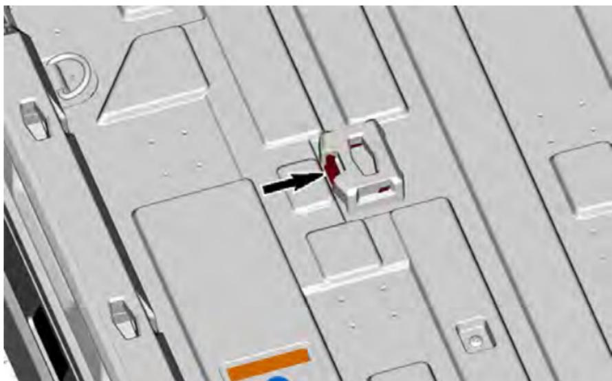
2. Positionieren Sie die LinQ-Befestigung in Richtung Mitte der Transportbox.
