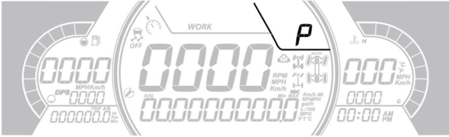
Diese Anzeige zeigt die Getriebestellung an:
