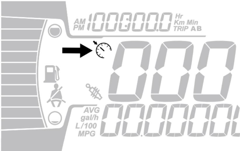
3. Der Bediener kann dann den Wert durch Drücken der OFF/ACCEL-Taste (kurzer Druck) erhöhen.
