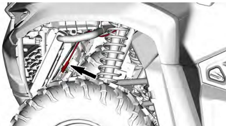
3. Entfernen Sie die Schrauben, die den Kühlerlüfter am Kühler sichern (2 auf der linken Seite, 2 auf der rechten Seite und 2 oben).
