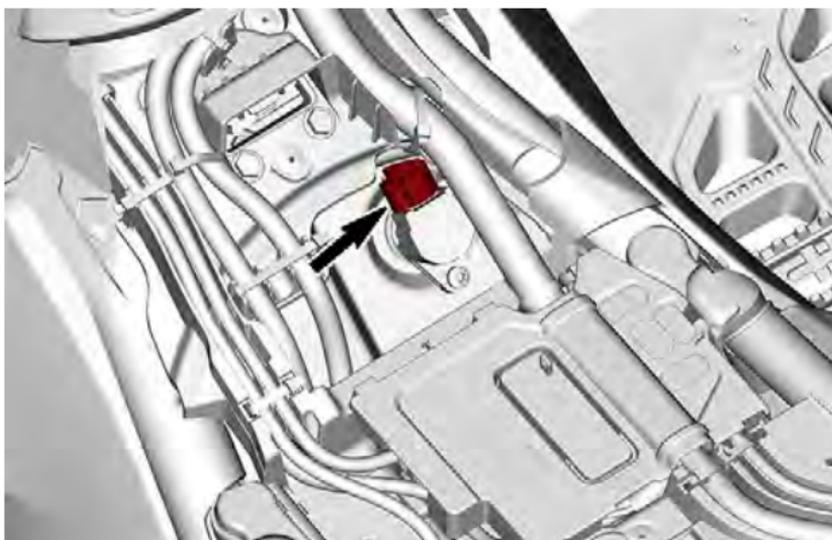
5. Entfernen Sie die Befestigungsschraube der Zündspule.
