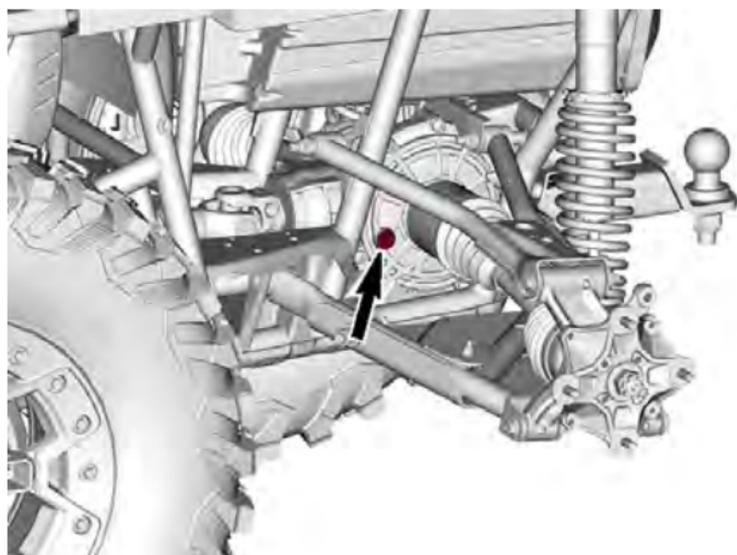
8. Entfernen Sie den Einfüllstopfen.
