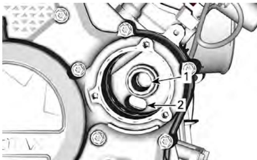
1. Auslass-Bohrung zur Ölspeisung des Motors
