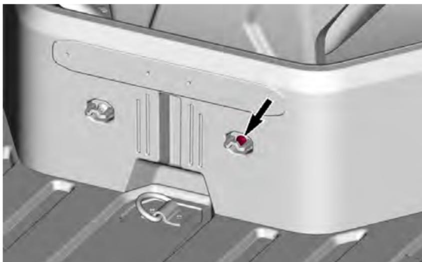
2. Entfernen Sie den Haken und setzen Sie die Schraube und die Unterlegscheibe wieder ein.
