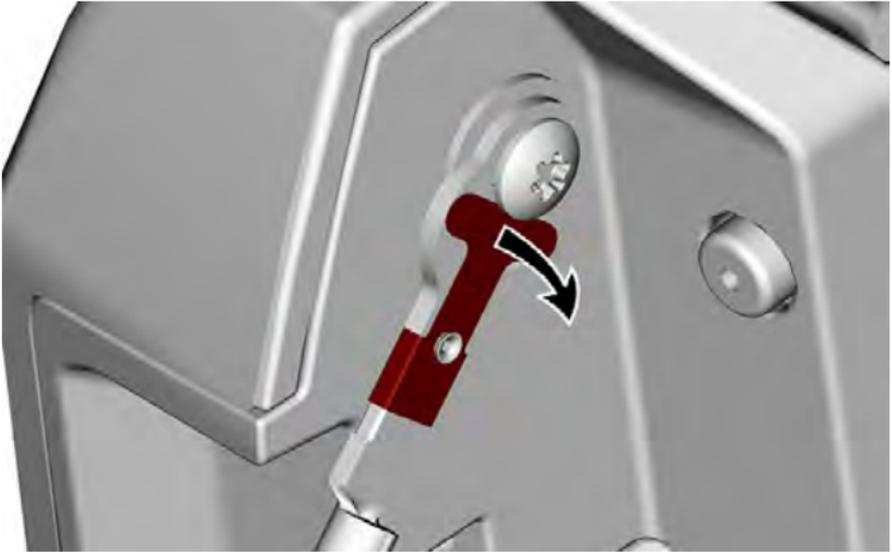
3. Heben Sie die Ladeklappe um 45° an.
