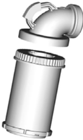
2. Setzen Sie den Luftfilteradapter und den Luftfilter in das Luftfiltergehäuse ein.
