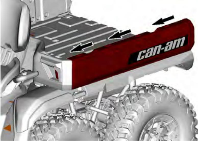
3. Verriegeln Sie die Seitenwand, indem Sie die hintere Verriegelung nach unten drücken.
