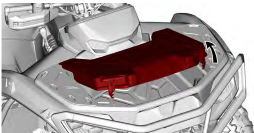
2. Drehen Sie den Hebel im Staufach, um die Abdeckung in der Offen-Stellung zu verriegeln.
