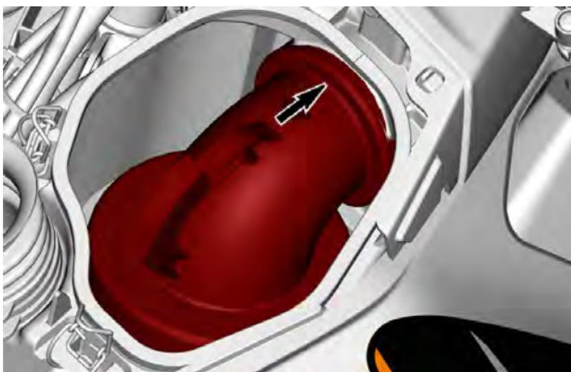
4. Bringen Sie den Abdeckung des Luftfiltergehäuses an.
