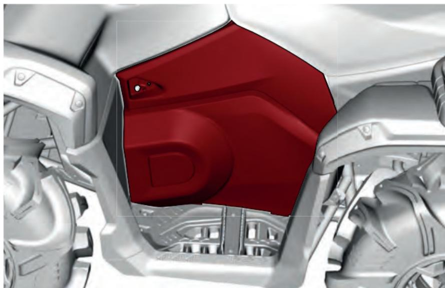
2. Remova o para-lama interno dianteiro esquerdo.
