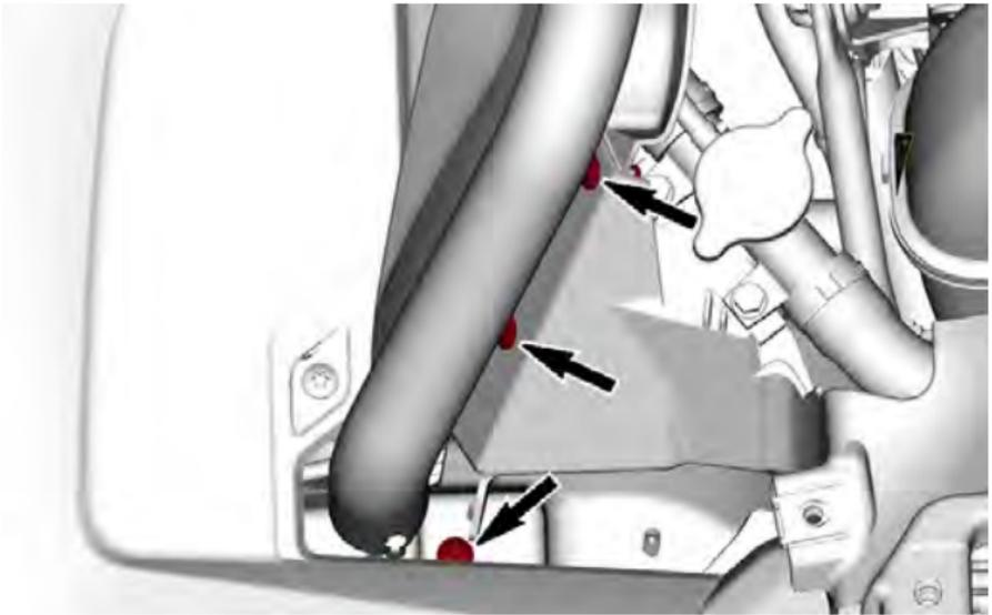
2. Remova ambos os parafusos retendo o bocal de abastecimento.
