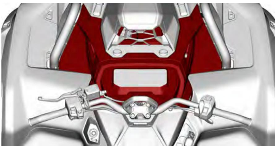
2. Com o veículo em uma superfície nivelada, o líquido deve estar entre as marcas de nível MÍN. e MÁX. do reservatório do líquido de arrefecimento.
