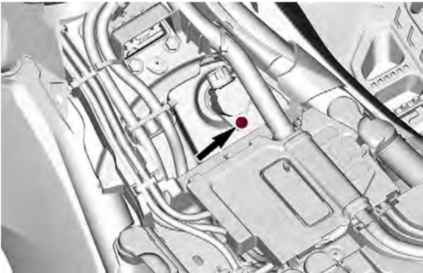
6. Retire a bobina de ignição.
