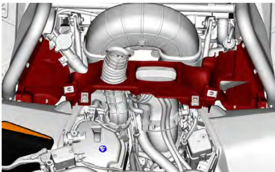
1. Remova os parafusos de retenção de cada lado do suporte.
