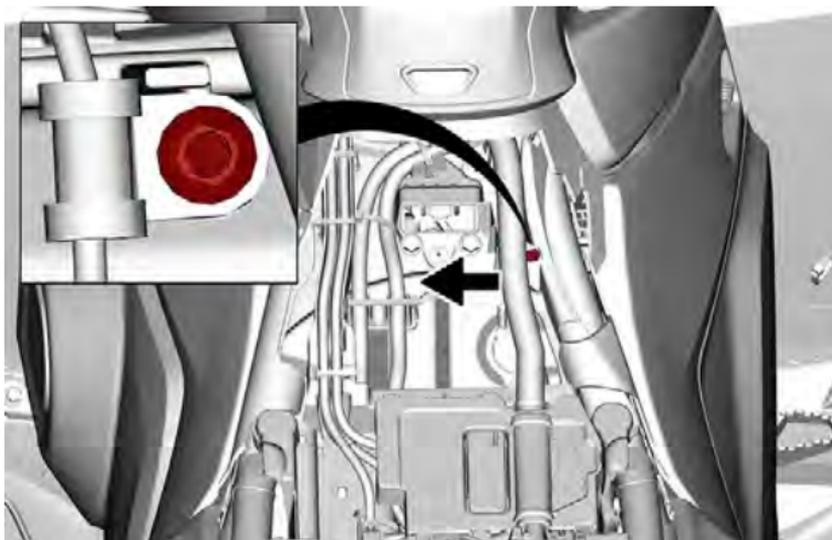
4. Desligue o conector da bobina de ignição.
