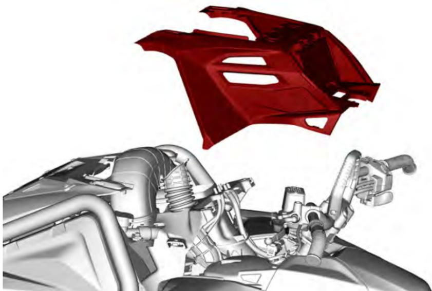
8. Desconecte os conectores elétricos dos componentes do console.
