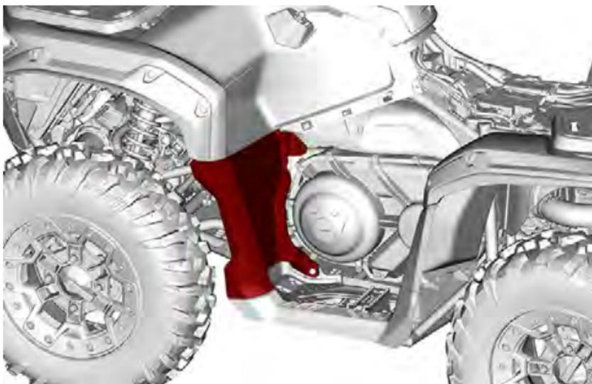
4. Desconecte o duto de refrigeração do ar de entrada da tampa da CVT.
