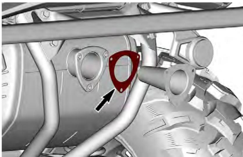
9. Instale a guarnição do escapamento.
