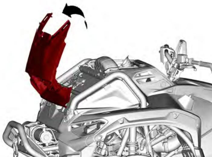
5. Desengate os dois parafusos de um quarto de volta no console.
