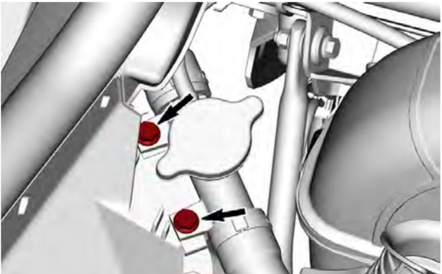
3. Remova o parafuso que fixa o reservatório do líquido de arrefecimento para o suporte.
