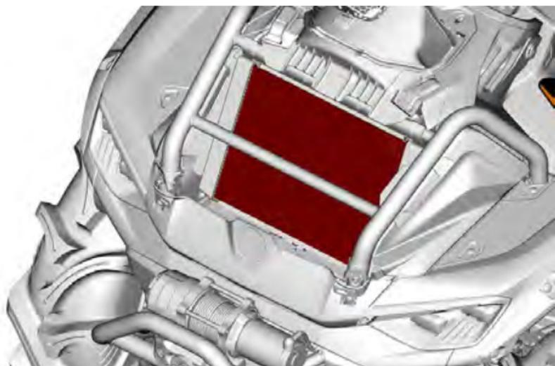
6. Inspeção o radiador e as mangueiras quanto a vazamentos e danos.
