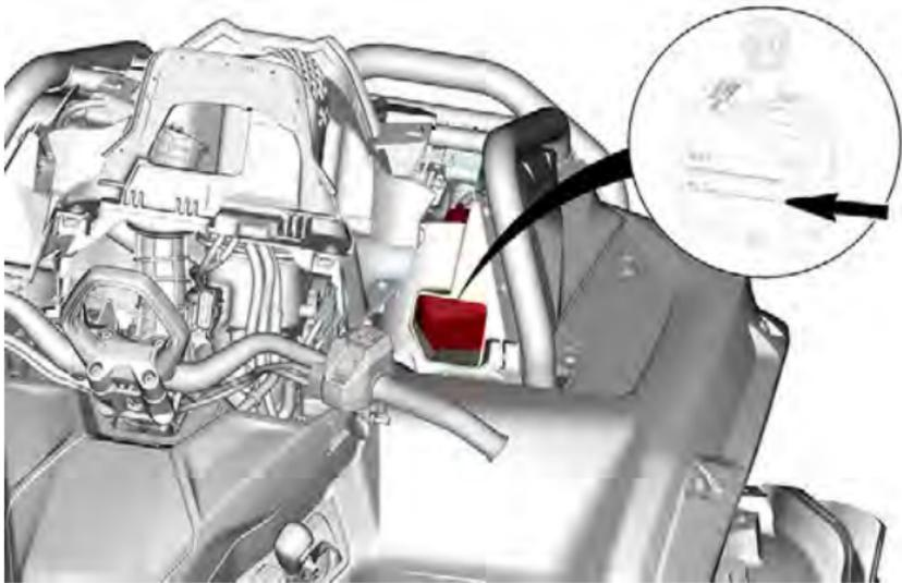
Para acrescentar líquido de arrefecimento no sistema, remova a tampa de pressão do líquido de arrefecimento.
