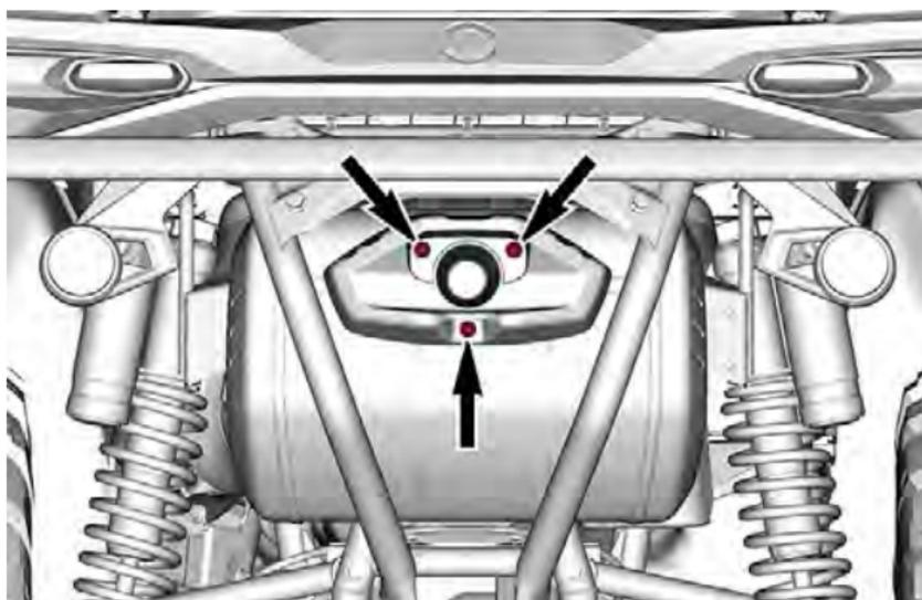
2. Remova a guarnição do escapamento.
