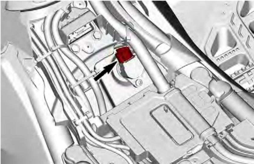
5. Remova o parafuso de retenção da bobina de ignição.
