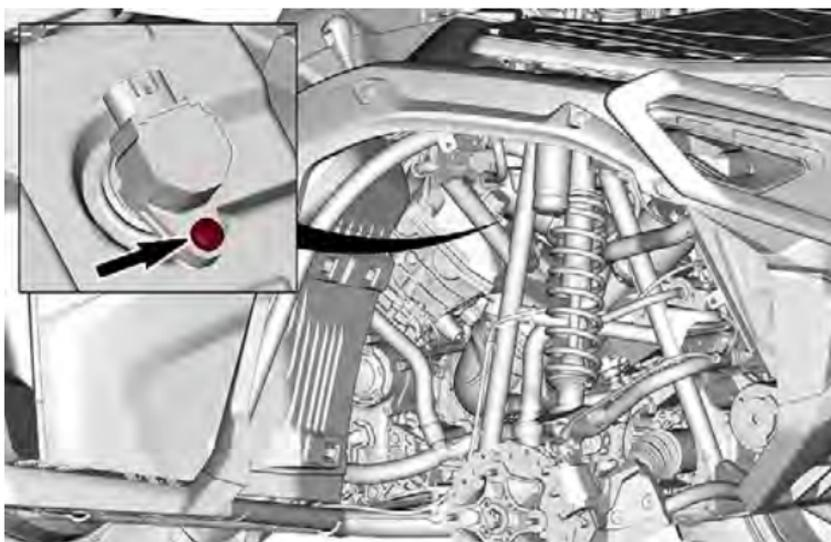
10. Retire a bobina de ignição.
