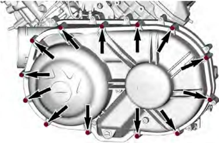
**Dica:** Remova o último parafuso superior central a suportar a tampa durante a remoção.
