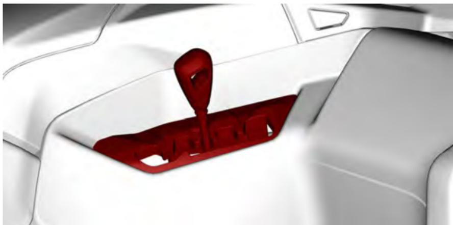
Mit dem Schalthebel wird die Getriebebestellung verändert.
