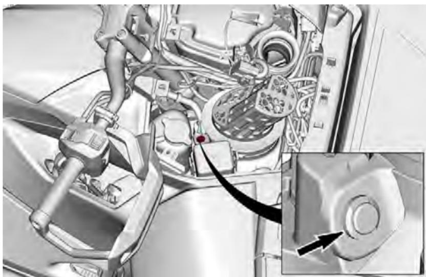
3. Montieren Sie einen neuen Kabelbinder und ziehen Sie die Schraubschelle fest.
