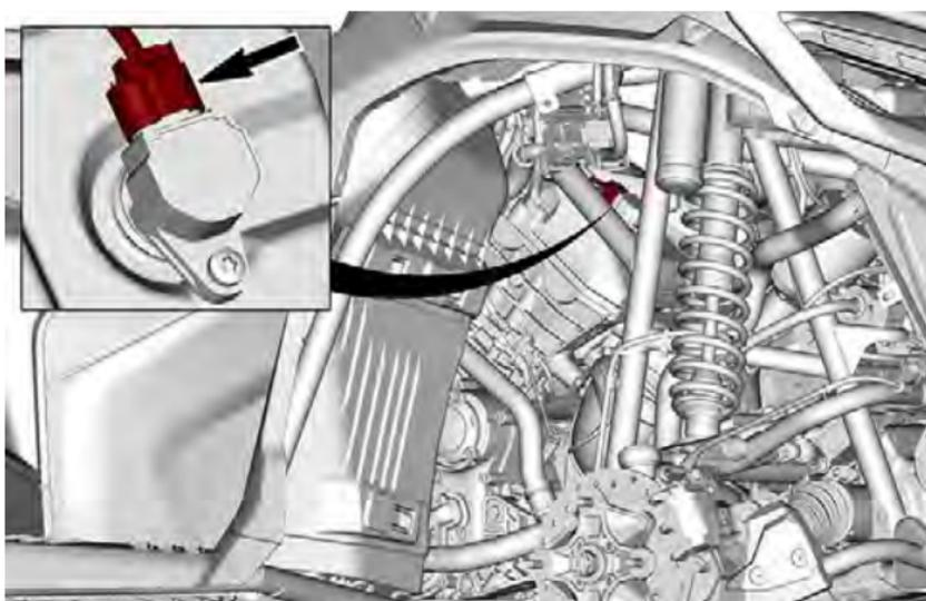
7. Entfernen Sie die Befestigungsschraube der Zündspule.
