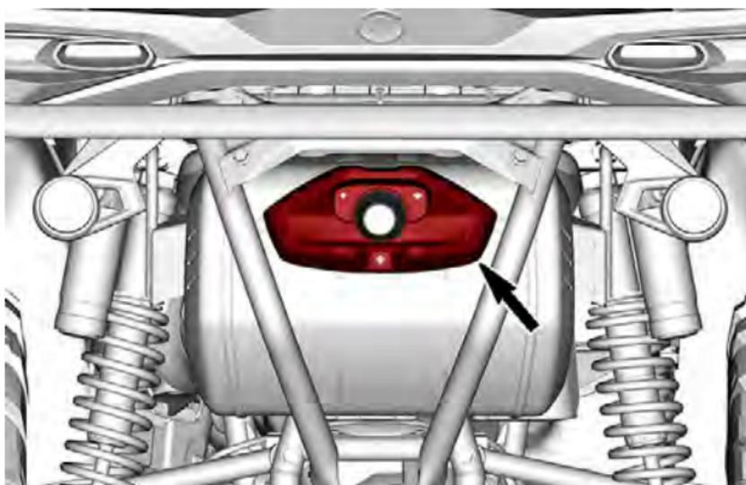
10. Befestigen Sie die Auspuffblende mit neuen Schrauben. Nach Vorgaben anziehen.
