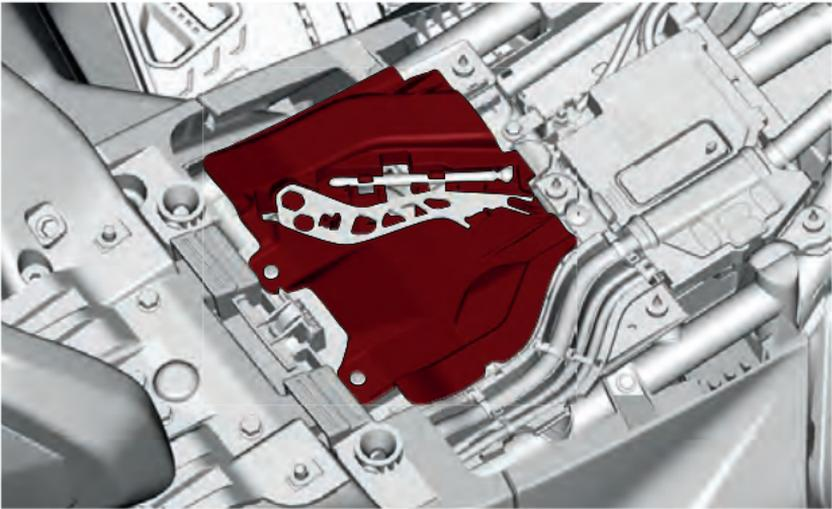
4. Trennen Sie die Kabelbinder, die den Filter an der Halterung sichern.
