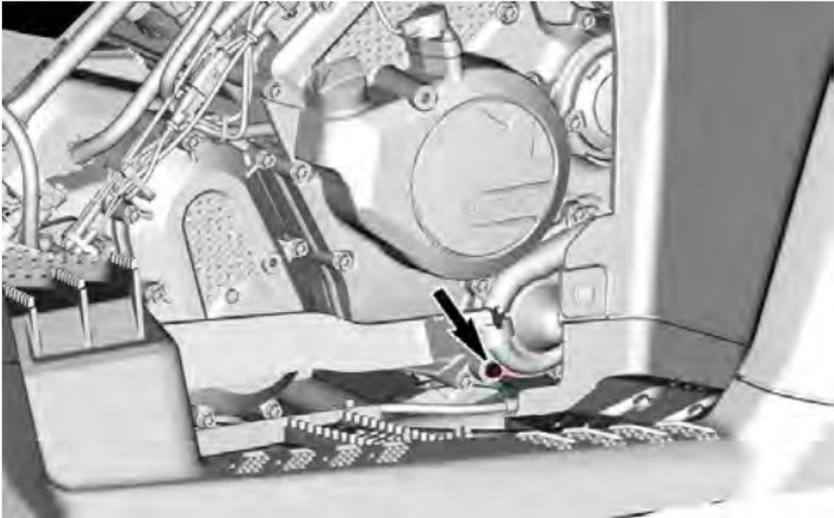
3. Zum Schluss lösen Sie den unteren Kühlerschlauch von der Abdeckung der Wasserpumpe und lassen Sie das übrige Kühlmittel in einen geeigneten Behälter ablaufen. Rangieren Sie die Oetiker-Schelle aus.
