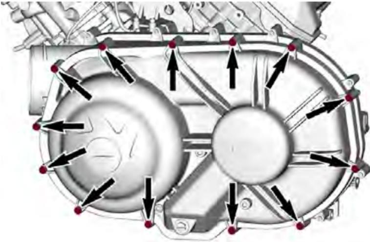
**Tipp:** Entfernen Sie die mittlere obere Schraube zuletzt, um die Abdeckung während des Ausbaus abzustützen.
