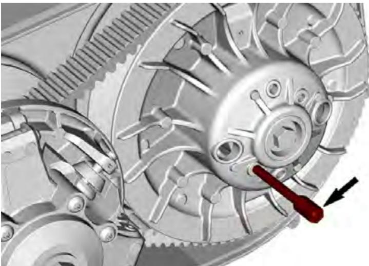
4. Drehen Sie die angetriebene Riemenscheibe, bis der unterste Teil der Zahnräder auf der Außenfläche des Antriebsriemen bündig mit der Kante der angetriebenen Riemenscheibe abschließt.
