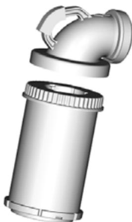
2. Setzen Sie den Luftfilteradapter und den Luftfilter in das Luftfiltergehäuse ein.
