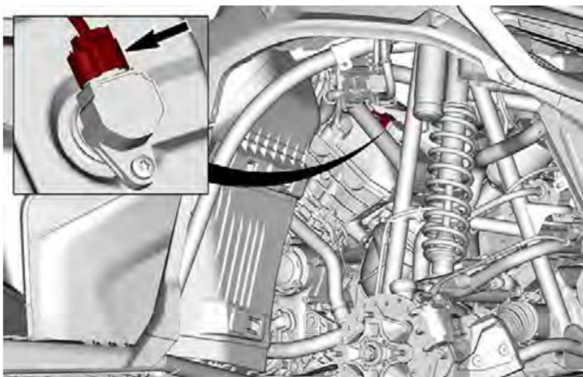
6. Montieren Sie die Schraube der Zündspulenklemme.
