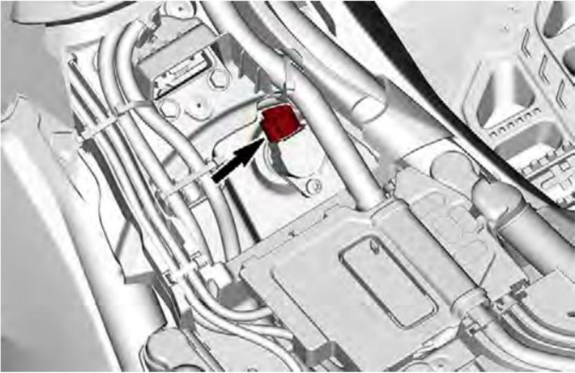
5. Entfernen Sie die Befestigungsschraube der Zündspule.
