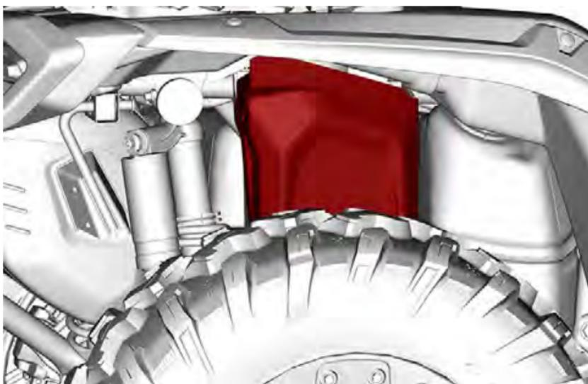
6. Den Batteriedeckel mit den zuvor entfernten Kunststoffnieten sichern.
