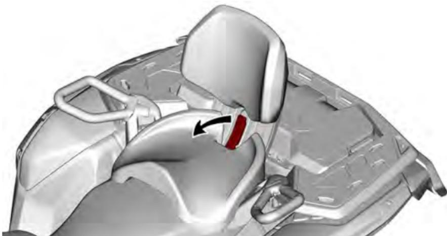
2. Bei nach vorne gedrücktem Verriegelungshebel drücken Sie die Rückseite des Verriegelungshebels nach unten, um den hinteren Hebel vom Stift zu lösen und drücken den Sitz mithilfe der Rückenlehne nach vorne.
