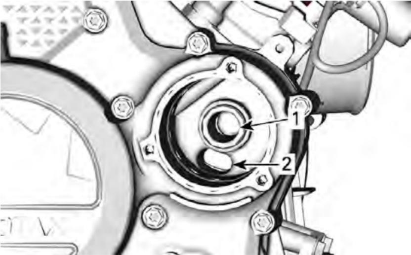
1. *Auslass-Bohrung zur Ölspeisung des Motors*
