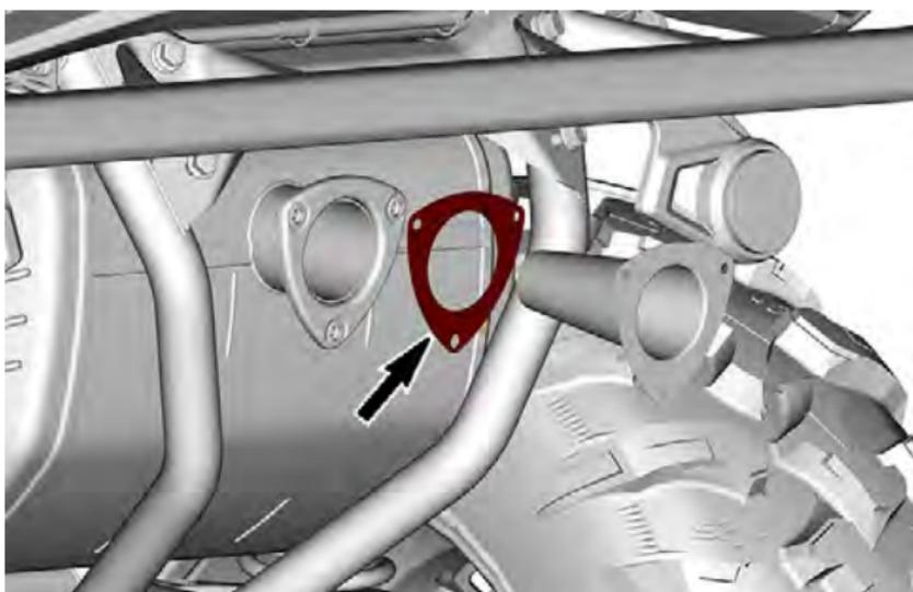
4. Entfernen Sie Kohleablagerungen vom Funkenschutz mit einer weichen Metallbürste.
