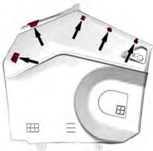
3. Sichern Sie die Seitenverkleidung, indem Sie den Sperrriegel drehen.
