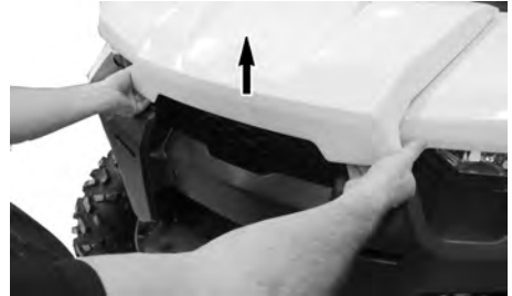
DE RAND VAN HET VOORSTE ONDERHOUDSDEKSEL OPTILLEN.
