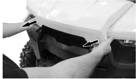
TIRARE DAL BORDO COPERCHIO DI MANUTENZIONE ANTERIORE.
