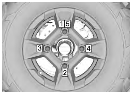
SEQUENZA DI SERRAGGIO
