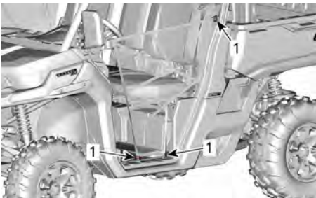
1. Posizione delle regolazioni per le protezioni laterali
