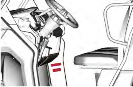
SITUAZIONE TIPICA - POSIZIONE ETICHETTA VIN
