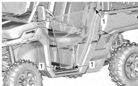
1. Ubicaciones de ajuste de las redes laterales
