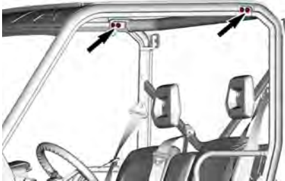
1. Sujeciones inferiores de la jaula
